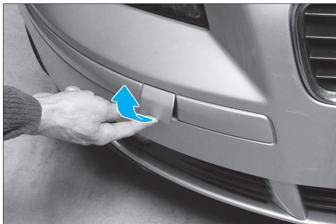
Dépose du cache anneau de remorquage (jusqu'à 06/2007) Tirer sur la partie inférieure du cache
