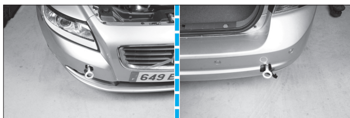
Mise en place de l'anneau de remorquage
