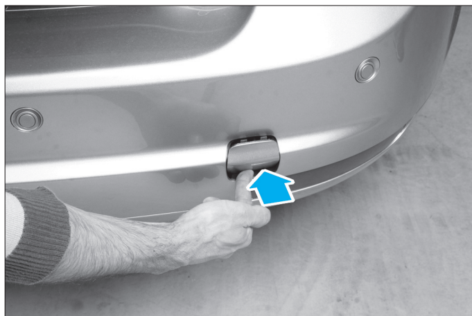
Dépose du cache anneau de remorquage (à partir de 06/2007) Appuyer sur la partie inférieure du cache
