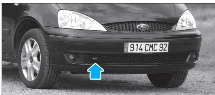
Implantation du crochet de remorquage avant
