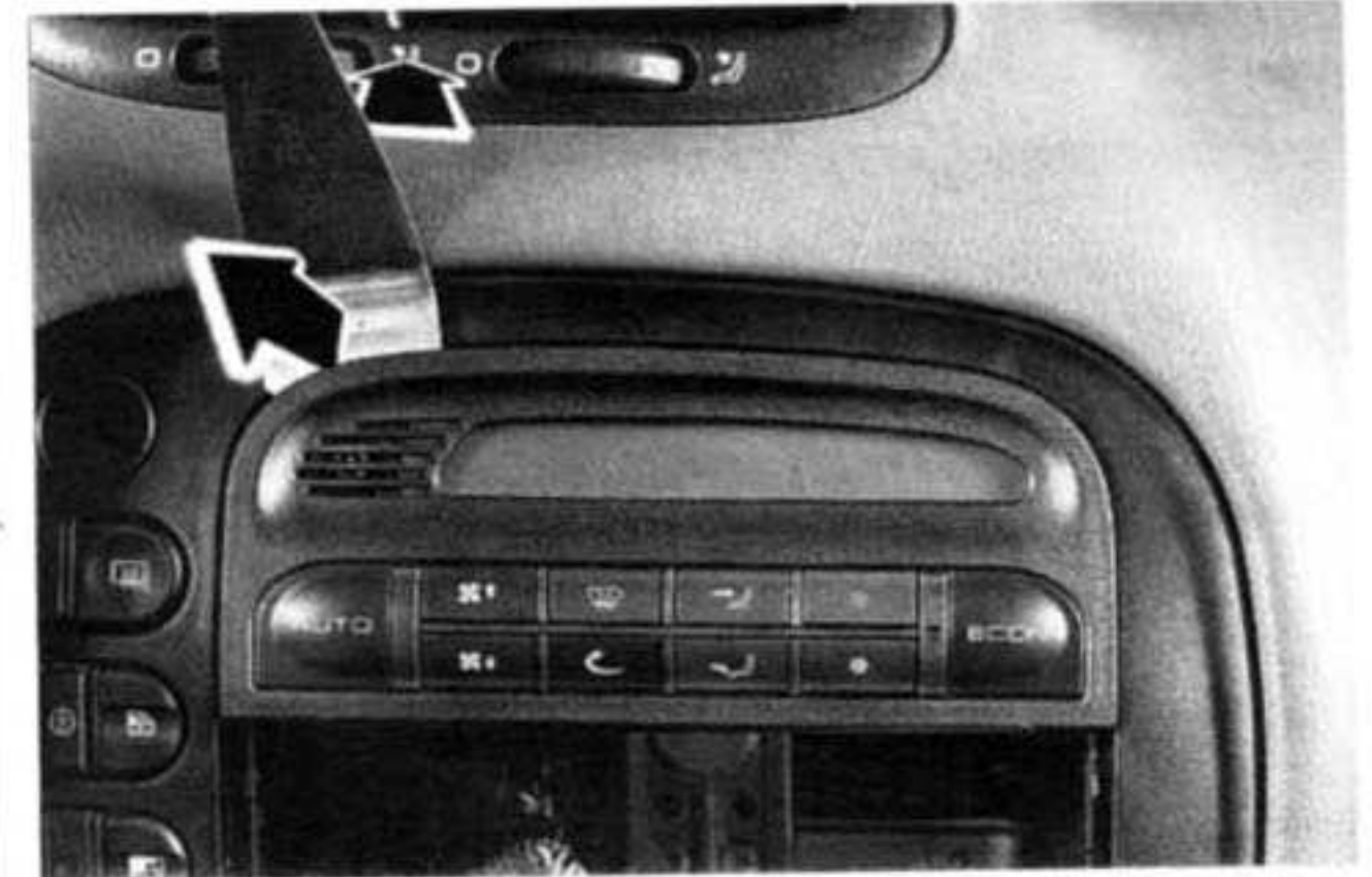
Dépose de la platine de commande de chauffage.
