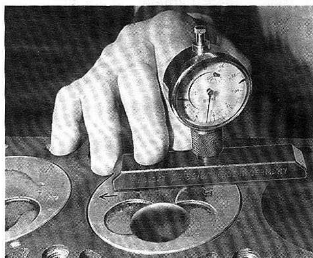
Mesure du dépassement des pistons.
