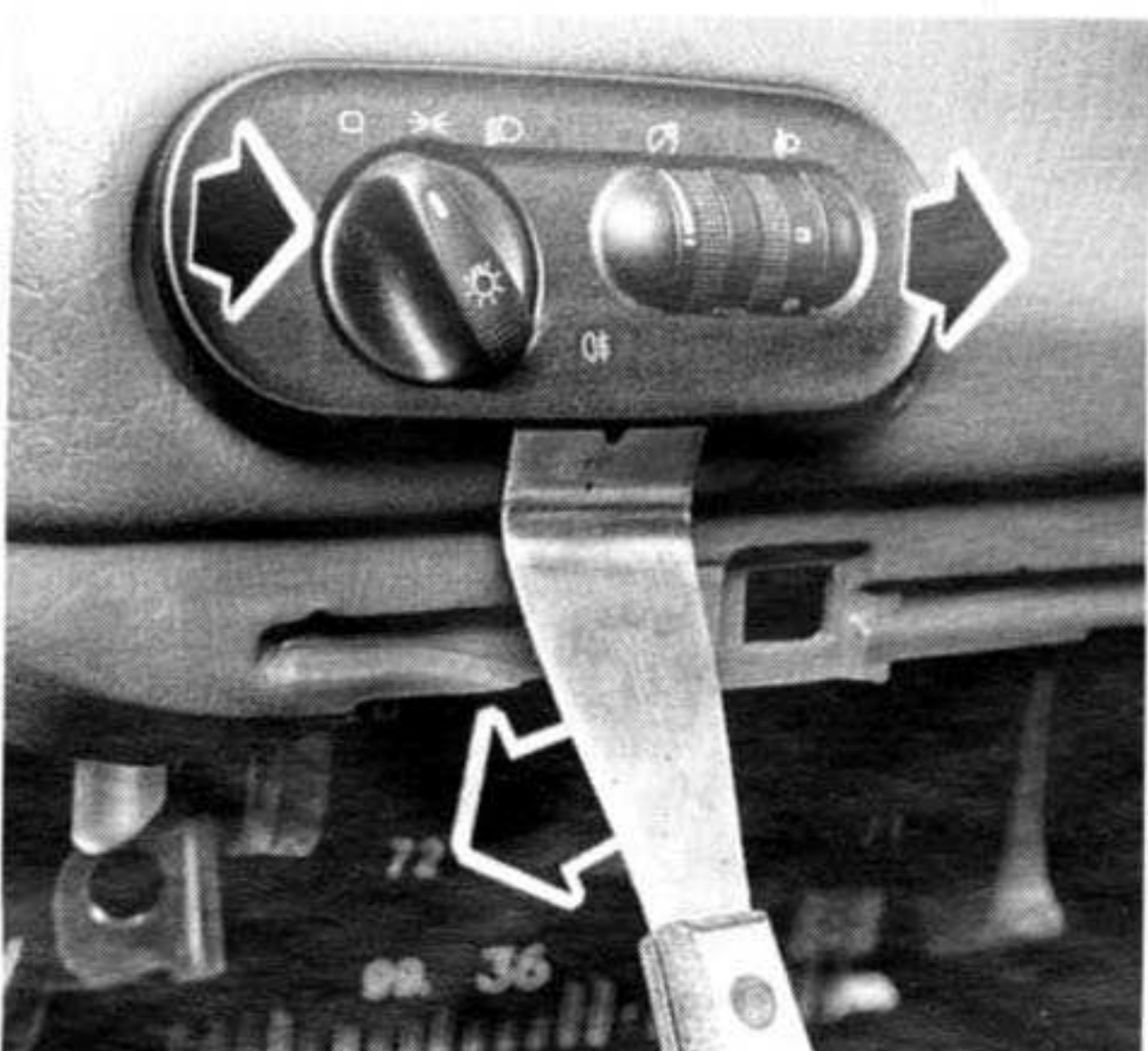
Dépose de la commande d'éclairage.
