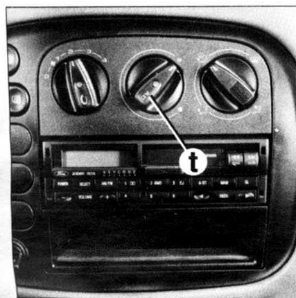
Commande de climatisation t. Lampe témoin de mise en fonction du climatiseur.
