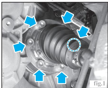
Repérer la position des vis de fixation de la rotule inférieure sur le pivot puis la déposer.
