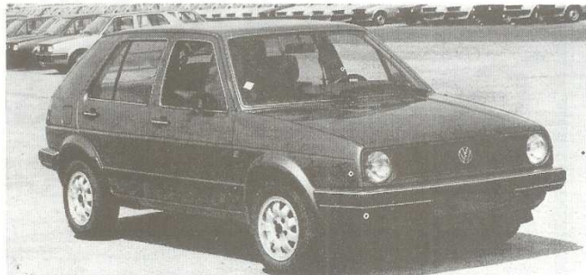
La nouvelle "Golf" ressemble à l'ancien modèle mais sa carrosserie aux formes plus ronde a été entièrement redessinée. L'empattement est rallongé entre le pied-milieu et l'essieu arrière. Ici une version grand luxe baptisée "Carat". (Photo RTA)
