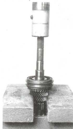
Dépose du synchroniseur de 3 e /4 e et du pignon fou de 3 e de l'arbre primaire.
