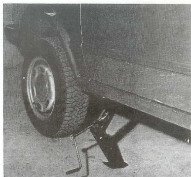
Mise en place du cric de bord. (Photo RTA).
