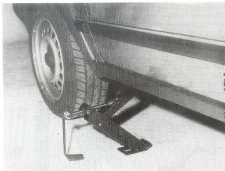
Mise en place du cric de bord. (Photo RTA).
