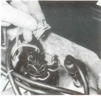
Fiche bleue du transmetteur de température, située entre les injecteurs des 1 er et 2 e cylindres
