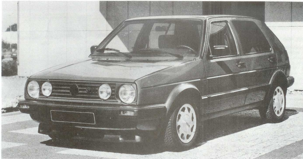
Au millésime 1988, la suppression des déflecteurs de vitres avant a permis d'avancer le rétroviseur extérieur. La calandre est nouvelle avec seulement 4 barrettes
