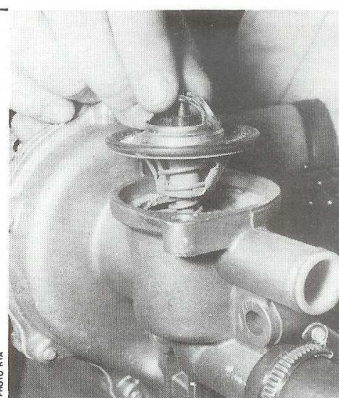
Position de montage du thermostat
