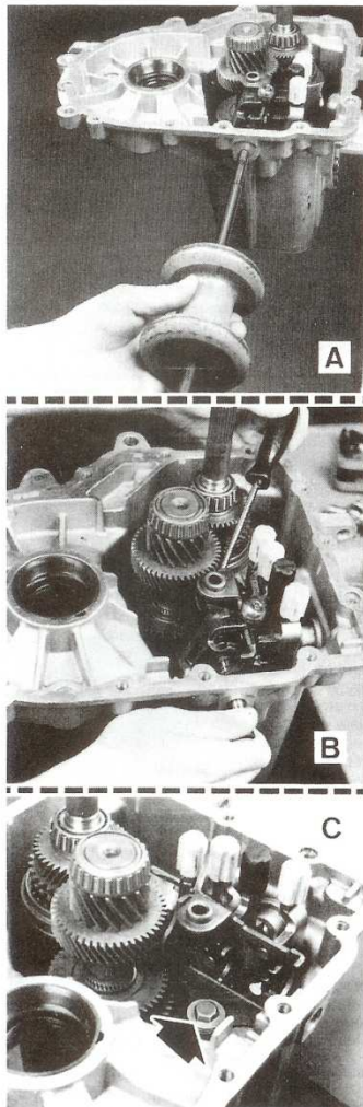
Dépose de la sélection interne des vitesses A. Extraction du bouchon d'obturation - B. Dépose de l'axe - C. Vis de fixation de la chape.
