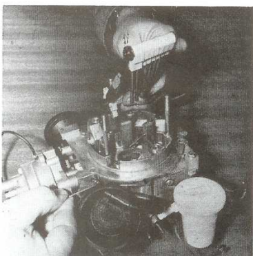
Réglage de l'ouverture du volet de départ
