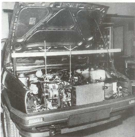
Mise en place de l'outil de maintien en place du moteur (VW 10 222)
