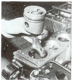
Orientation de la bielle et du piston
