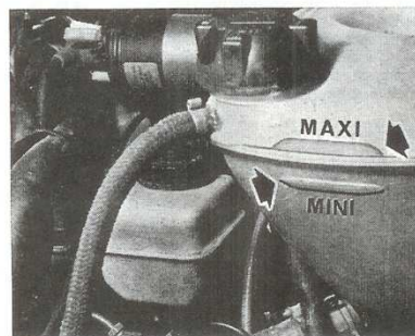
Repères de niveaux mini et maxi sur vase d'expansion du circuit de refroidissement. (Photo RTA).
