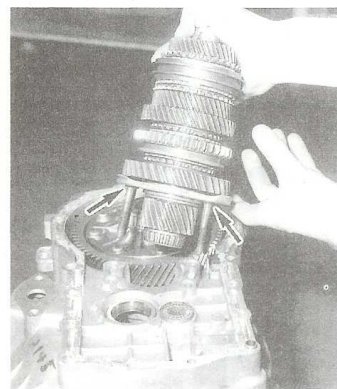
Mise en place de l'arbre secondaire. Flèche : joints toriques.
