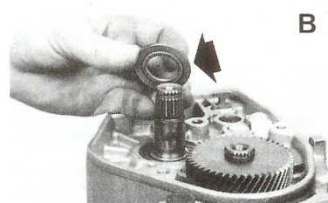
A. Dépose de la bague intérieure du roulement à aiguilles du pignon de 5 e et de la rondelle d'appui - B. Sens de montage de la rondelle d'appui.
