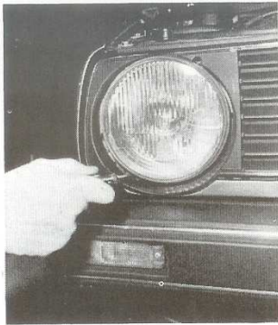
Réglage des phares En bas : réglage en hauteur - En haut : réglage latéral
