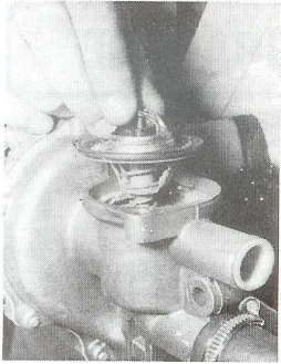
Mise en place du thermostat
