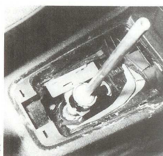
Mise en place du calibre de position (outil VW 31-04)
