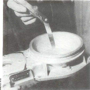
Contrôle du centrage du plateau de débitmètre d'air
