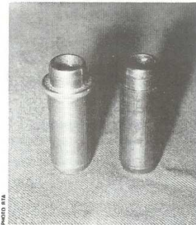
Guides de soupape à gauche réparation - à droite origine
