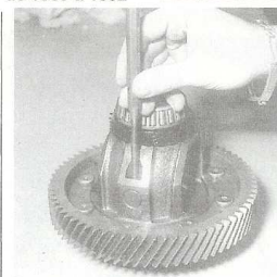
Enfoncer la goupille dans l'axe des satellites avant de le chasser.
