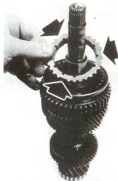
Mise en place de la bague de syn- chroniseur de 1 re Flèches : dents manquantes espa- cées de 120°.
