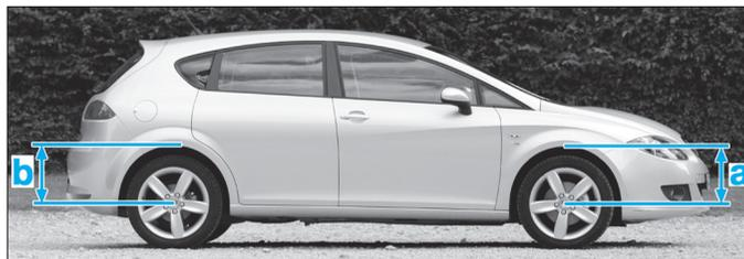
a. Hauteur de caisse avant - b. Hauteur de caisse arrière.
