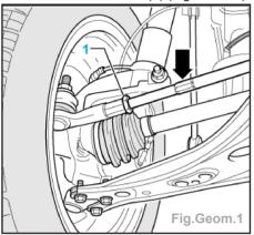
Régler le parallélisme en tournant la barre d'accouplement de direction gauche et / ou droite. Pour cela on peut mettre une clé dans la section hexagonale (flèche) de la barre de la direction.
