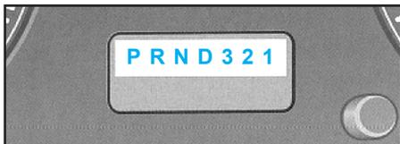
**Attention :** pendant la marche du véhicule, n'engagez jamais le levier sélecteur dans la position «**R**» ou «**P**». La boîte de vitesses risque d'être endommagée - danger d'accident!
