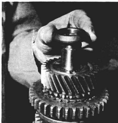
Montage de la rondelle arrière de pignon de 4 e
