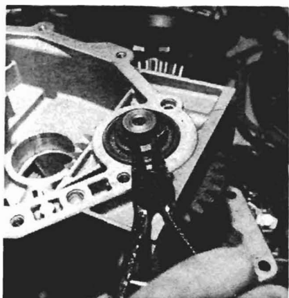
Dépose du circlip d'arbre primaire
