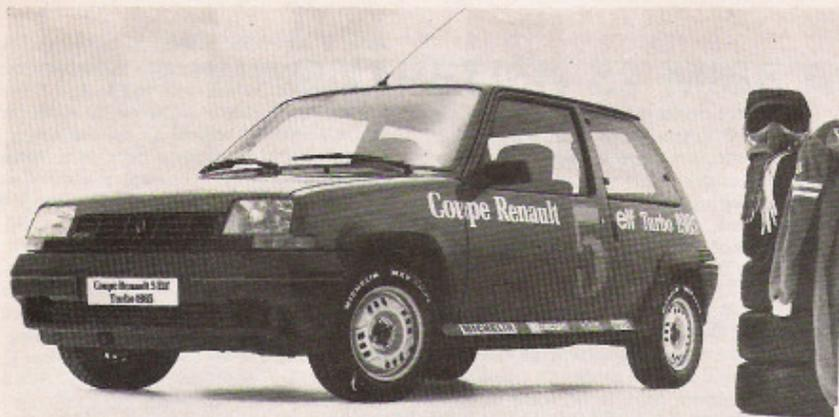
La Renault « 5 GT Turbo » possède des extensions d'ailes dont l'encombrement se combine avec celui des boucliers avant et arrière plus larges. Les deux trous du bouclier avant débouchent sur des écopes refroidissant les freins avant. Ici la version « Coupé », prête pour le « Coupé Renault 5 Elf », avec des roues en acier chaussées de pneus Michelin « MXV » spéciaux
