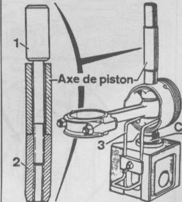
Mise en place d'un axe de piston (outil Mot 574.07)
