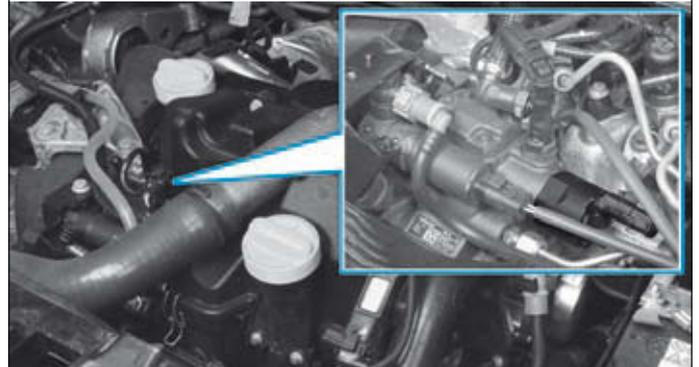
Le régulateur de pression de carburant est alimenté via F13 de l'unité de protection commutation moteur (UPC). Il est commandé par la masse selon un rapport cyclique d'ouverture.
