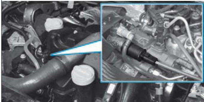
Le régulateur de débit de carburant est alimenté via F13 de l'unité de protection commutation moteur (UPC). Il est commandé par la masse selon un rapport cyclique d'ouverture.
