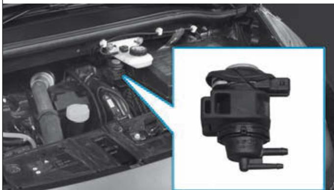
L'électrovanne de suralimentation est alimentée via F13 de l'unité de protection commutation moteur (UPC). Elle est commandée par la masse selon un rapport cyclique d'ouverture.
