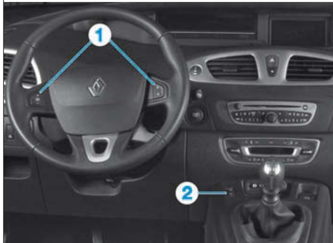
1. Contacteurs de commande du régulateur-limiteur de vitesse
