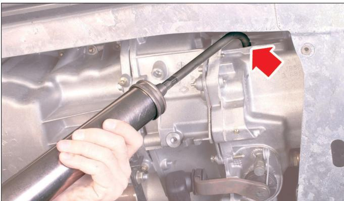
◀ Seringue permettant un remplissage aisé de la boîte de vitesses.
