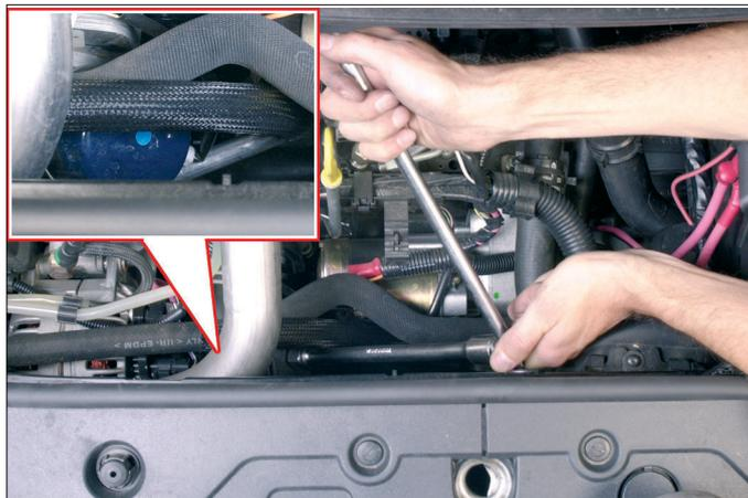
▲ Dépose du filtre à huile (moteur 1.5 dCi) à l'aide d'une clé auto-réglable.
