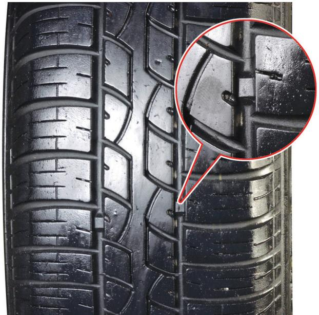
**Contrôle de l'usure du pneumatique. Vérifier le retrait de l'usure du témoin par rapport à la surface de contact. ►**
