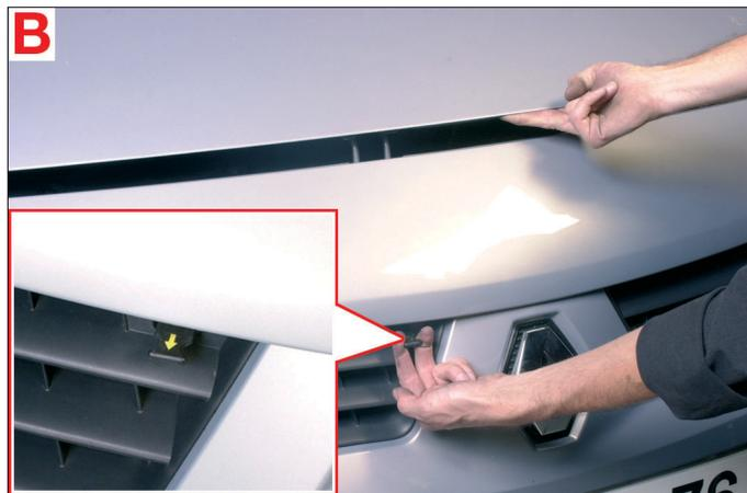
▲ Lever légèrement et tirer la palette de déverrouillage du capot moteur.
