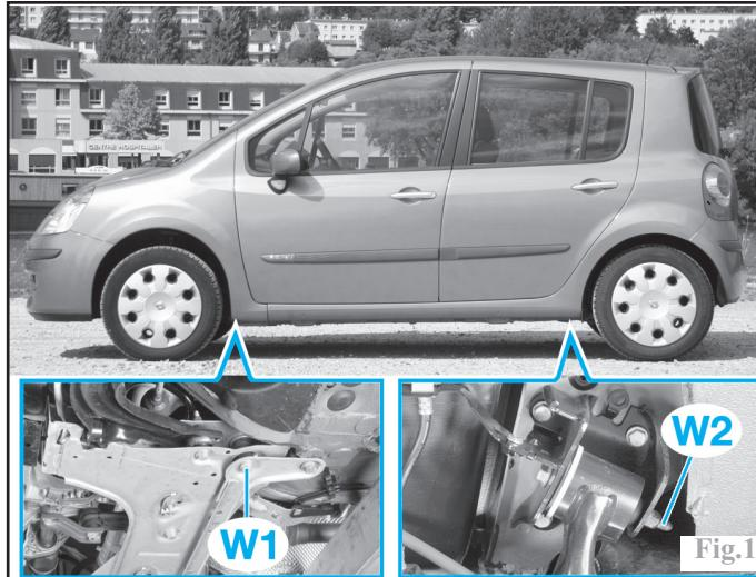
**W2** : distance comprise entre l'axe de rotation du train arrière sur son palier et le sol.
