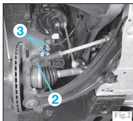
Repousser la transmission du pivot en pivotant celui-ci et en l'abaissant pour le dégager de l'amortisseur.
