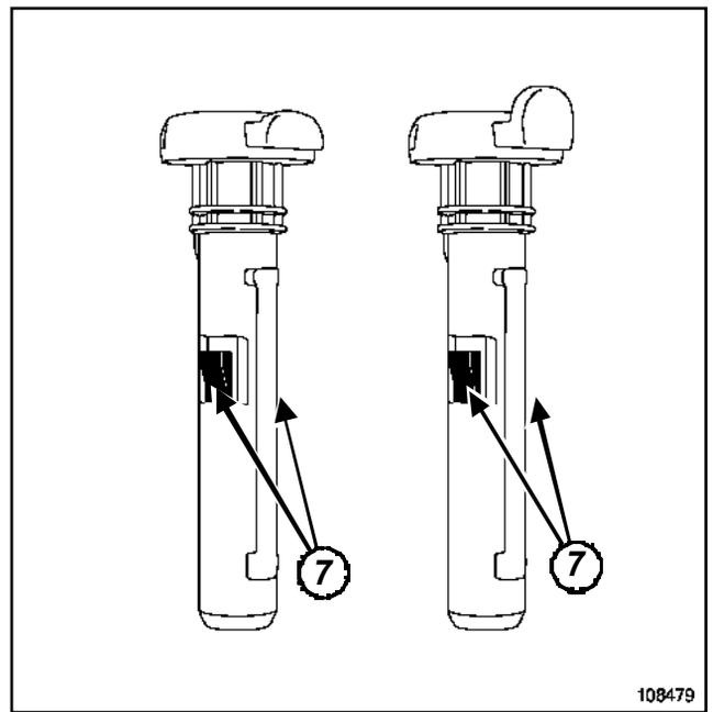
Appuyer sur les clips (7) à l'aide d'un tournevis plat.
