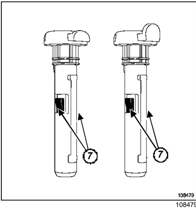
Appuyer sur les clips (7) à l'aide d'un tournevis plat.
