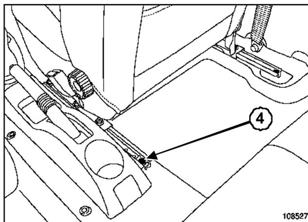
Serrer au couple la vis de fixations de siège (21 N.m)(4).
