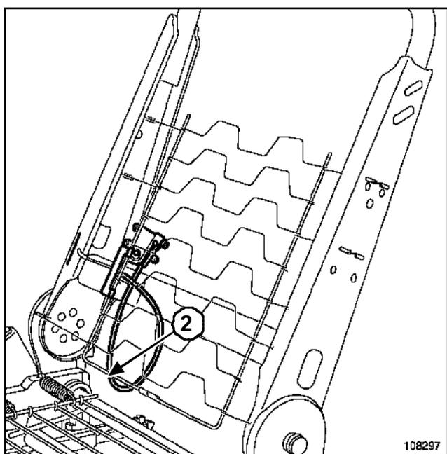
Déposer le câble de commande (2).
