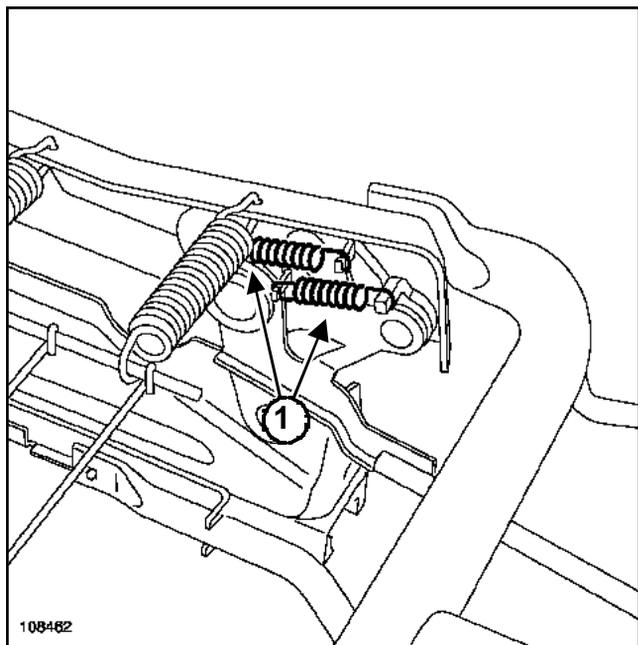
Déposer les ressorts de rappel (1) à l'aide d'un tournevis plat.
