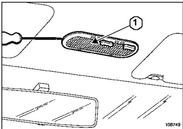
Déclipper à l'aide d'un tournevis plat, la vitre (1) de l'éclairage intérieur.
