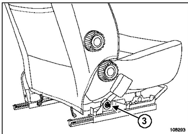
Déposer l'écrou (3).
