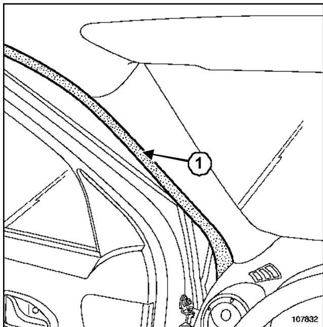
Déposer partiellement le joint d'étanchéité de porte (1).
