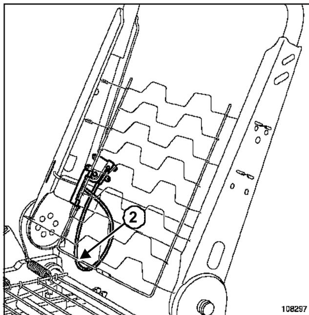
Déposer le câble de commande (2).
