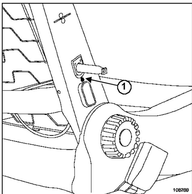
Déposer le rivet (1).
