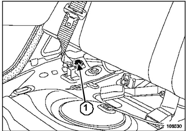
Déposer les vis (1) de fixation des ceintures.
