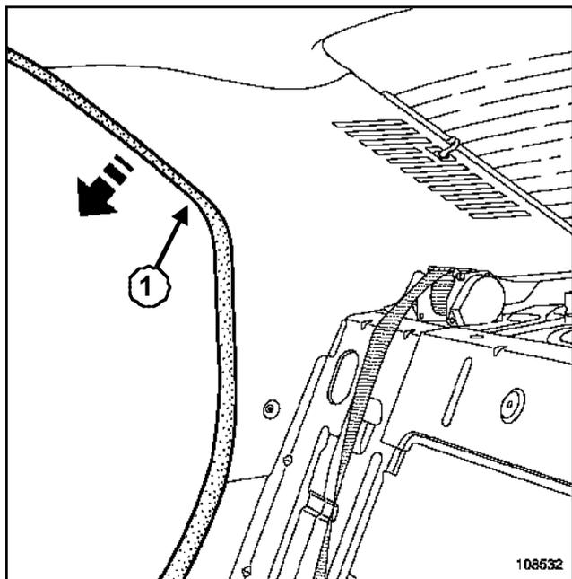
Déposer partiellement le joint (1).
