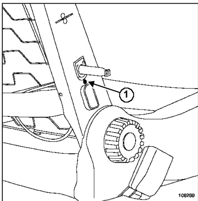
Déposer le rivet (1).
