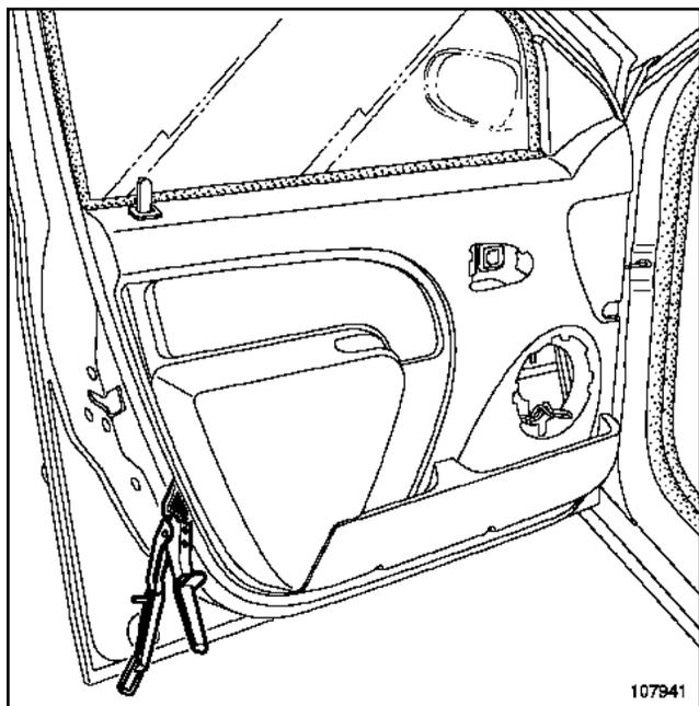
Déclipper la garniture à l'aide d'une pince à dégrafer.
