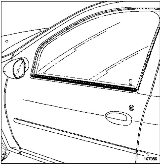
Déposer le lécheur extérieur avec précaution.
