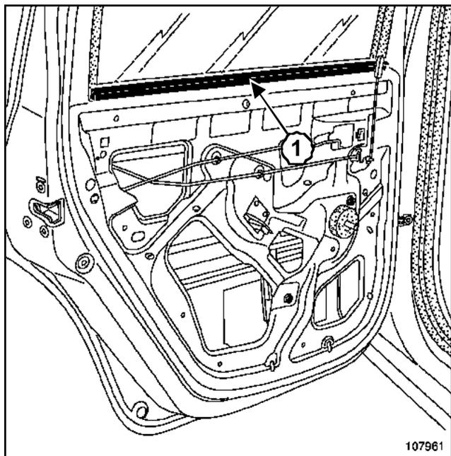
Déposer le lécheur intérieur (1).
