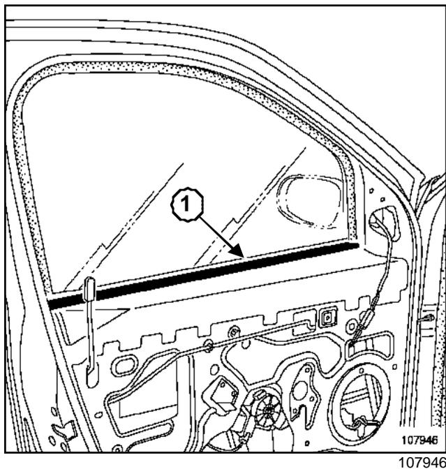
Déposer le lécheur intérieur (1).
