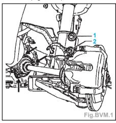
• les fixations de la transmission sur la boîte de vitesses (flèches).
