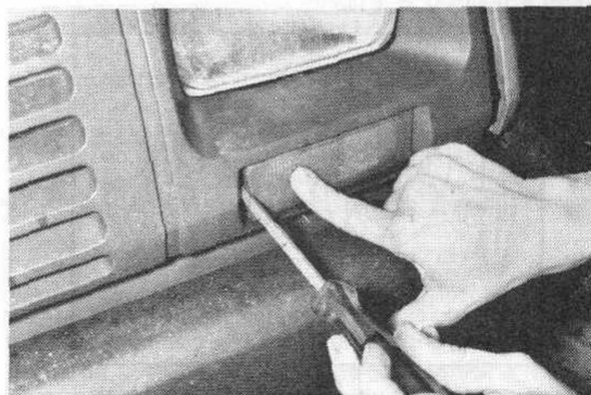
Sur les Express, déboîter le clignotant à l'aide d'un tournevis (Photo RTA)
