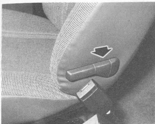
Levier de réglage d'inclinaison de dossier de siège avant (Photo RTA)
