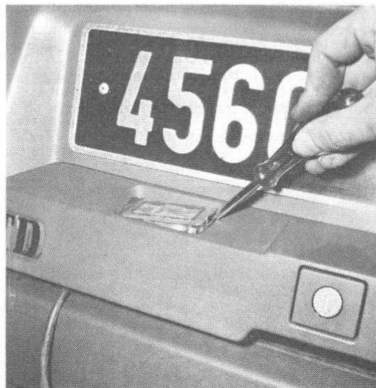
Berline : Dépose du transparent d'éclairage de plaque minéralogique (Photo RTA)
