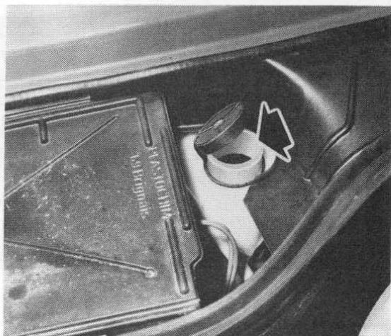
Réservoir de liquide lave-glace, situé près de la batterie (Photo RTA)
