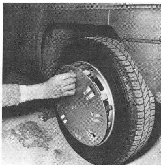
Dépose de l'enjoliveur de roues sur modèle « GTD » (Photo RTA)
