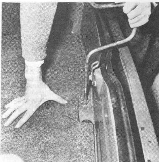
Dévissage du crochet de maintien de berceau de roue de secours (Photo RTA)
