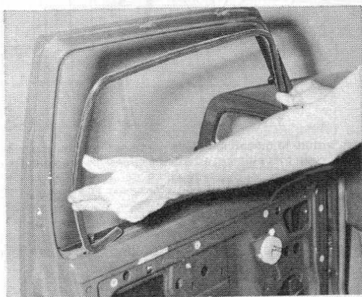
Dégager le lécheur de glace pour déposer la glace
