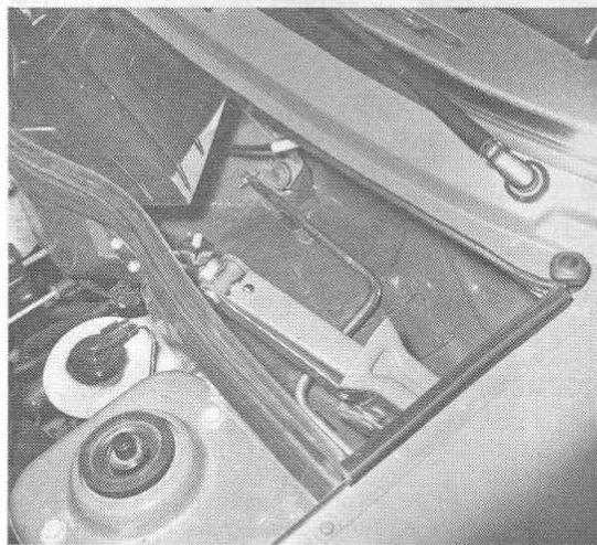
Emplacement du cric et de la manivelle (Photo RTA)
