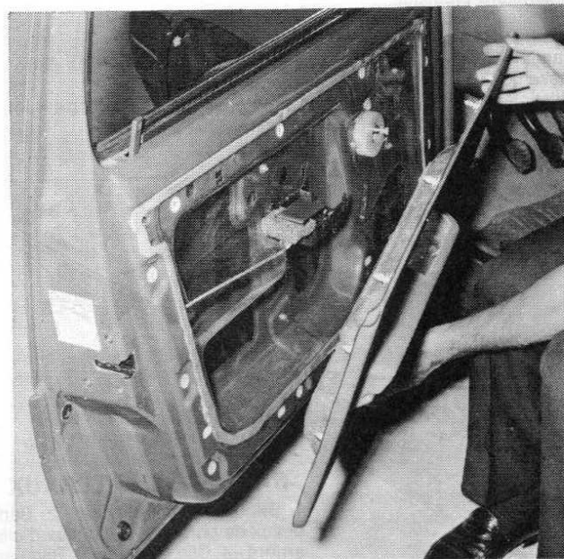
Il est impératif de replacer le film en plastique après manutention du garnissage de porte. Ce dernier évite les infiltrations d'eau dans l'habitacle
