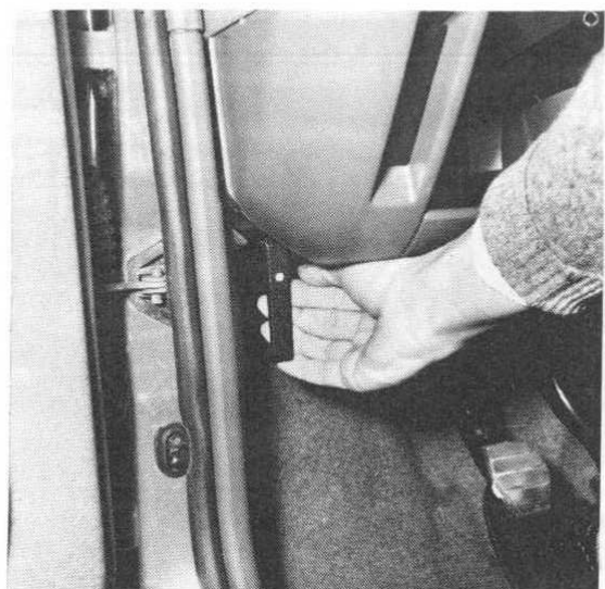
Levier d'ouverture du capot-moteur (Photo RTA)
