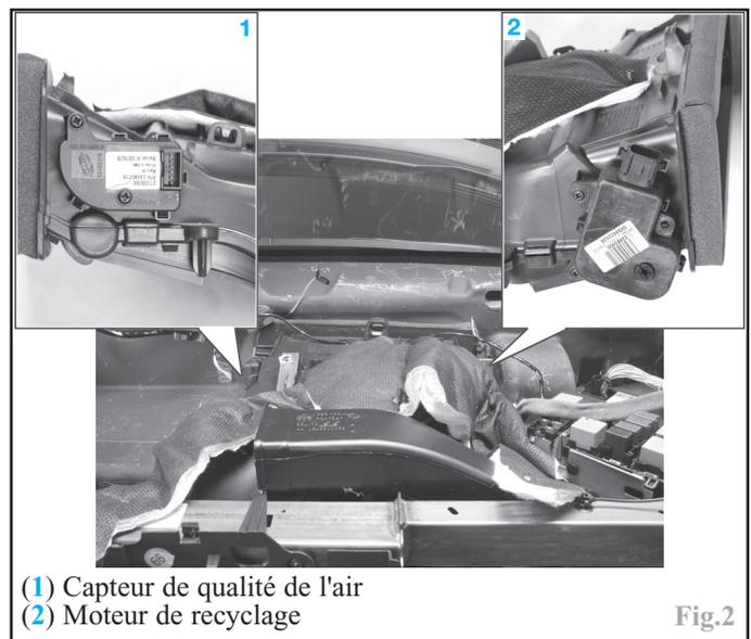
Le capteur est protégé par une membrane qui laisse passer les molécules de gaz mais arrête l'humidité et la poussière.
