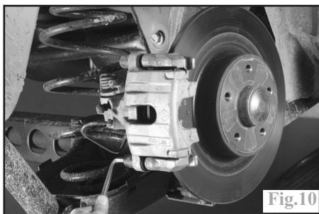
Repousser le piston d'étrier de frein jusqu'en butée à l'aide de l'outil Renault **Fre.1190-01** ou bien à l'aide d'une pince-bec (Fig.11).
