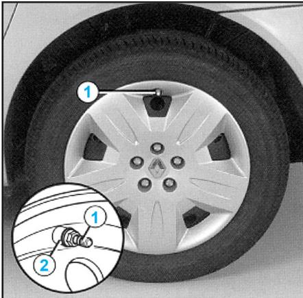
**Attention** : chacun des capteurs implantés dans les valves **1** est dédié à une seule et unique roue : il ne faut donc en aucun cas intervenir les roues. Risque d'information erronée pouvant entraîner des conséquences graves.
