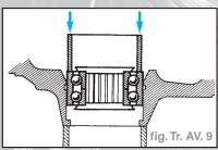
Attention: Ne pas prendre appui sur la bague intérieure pour ne pas détériorer le roulement car l'effort d'emmanchement est important.
