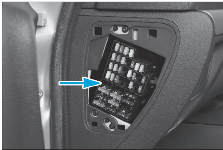
IMPLANTATION DU BOÎTIER FUSIBLES DE L'HABITACLE
