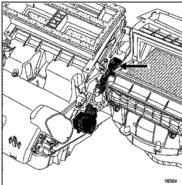
Le moteur de distribution a pour effet de positionner le volet d'entrée d'air selon les besoins déterminés par la régulation.
