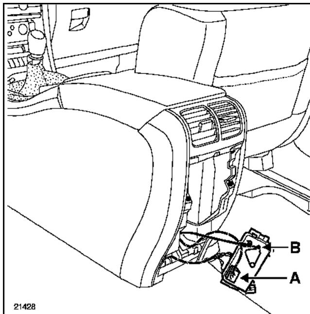
Débrancher le connecteur (A) et déposer le câble de commande (B).
