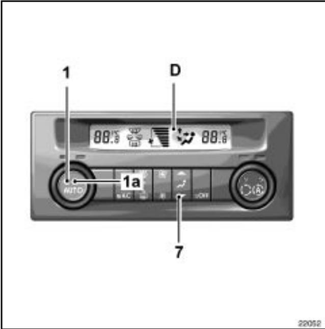
Le fonctionnement normal du système est le mode automatique, mais il est possible de modifier le choix imposé par le système (quantité d'air, distribution...).
