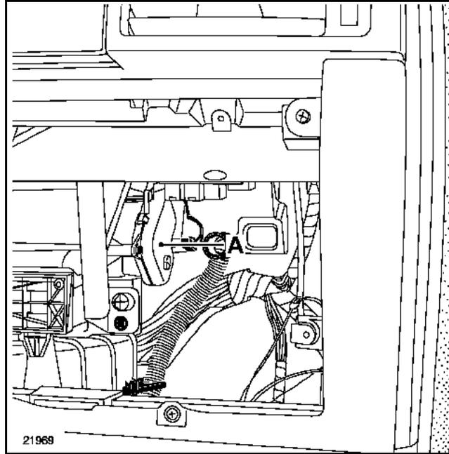
Le moteur de recyclage a pour effet de positionner le volet d'entrée d'air selon les besoins déterminés par la régulation.
