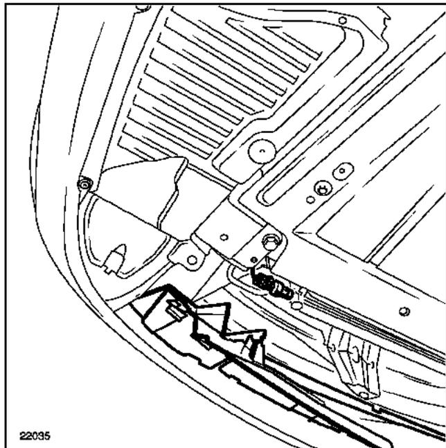
Le capteur de pression installé à la sortie du condenseur assure la protection du circuit réfrigérant.
