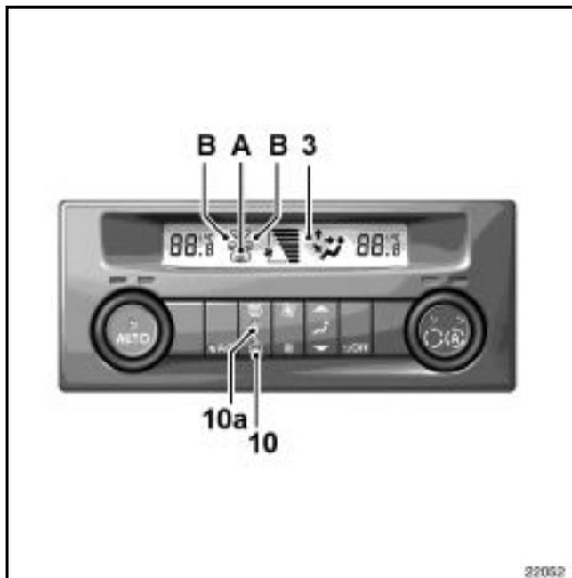
Appuyer sur la touche (10), le témoin de fonctionnement (10a) s'allume, et les témoins (A) et (B) apparaissent sur l'afficheur (3).
