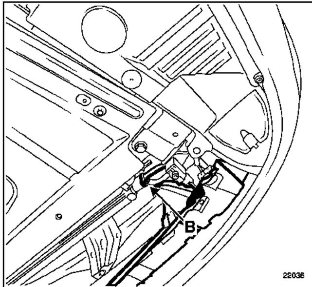
– l'écrou (B) de fixation sur le condenseur,
