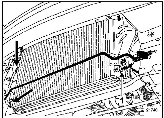
Déposer les raccords des tuyaux de la boucle froide sur le condenseur et les obturer.
