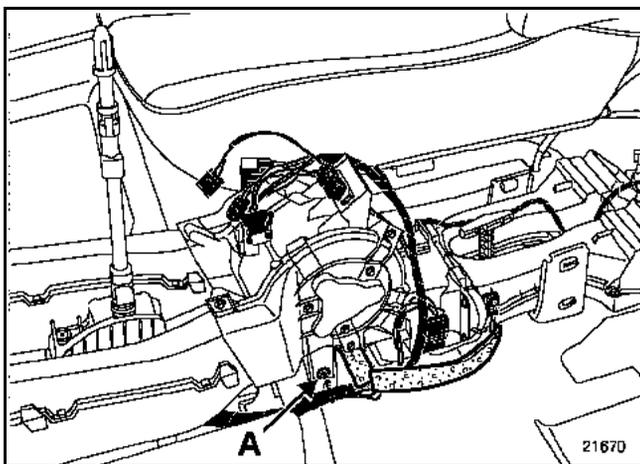
**NOTA** : la dépose du boîtier de résistance ne nécessite pas la dépose du groupe motoventilateur.
