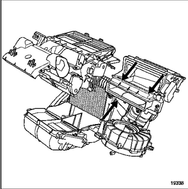
Ouvrir le boîtier répartiteur (F) suivant le schéma ci-dessous.
