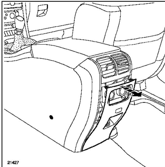
Déposer la connectique du contacteur de verrouillage de centralisation des portes et de l'allume-cigares.
