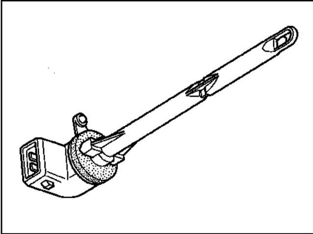
La sonde évaporateur a pour but d'informer de la température en sortie d'évaporateur.
