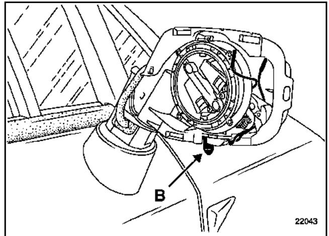
Positionner la sonde de température par le bas et, à l'aide d'un tournevis plat, pousser en (B).
