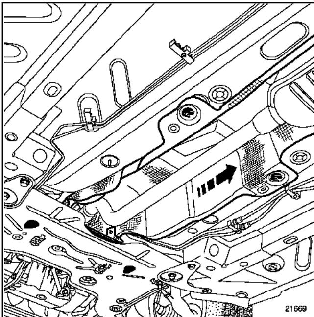
Enlever les fixations de l'écran thermique moteur et le décaler légèrement afin de pouvoir intervenir sur les écrous des tuyaux de climatisation situés à la jonction du tablier.
