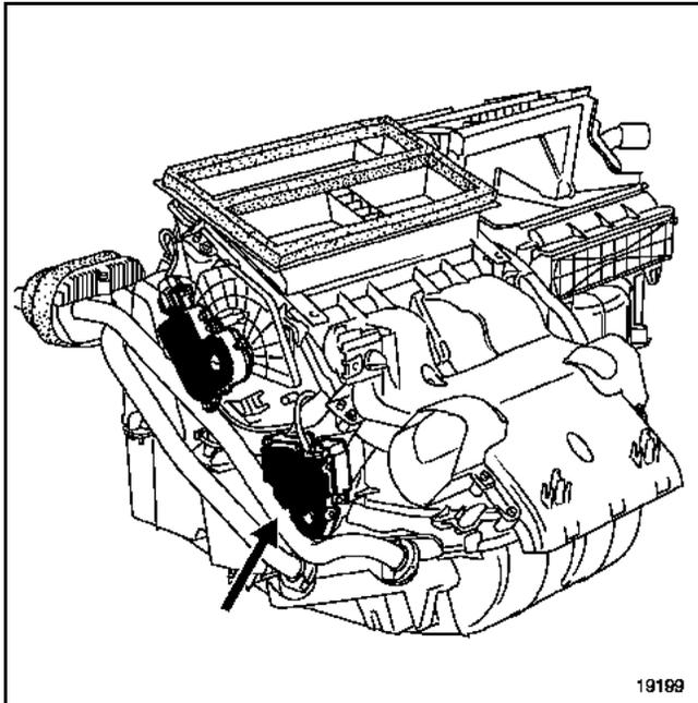
Le moteur de mixage a pour effet de positionner le volet d'entrée d'air selon les besoins déterminés par la régulation.
