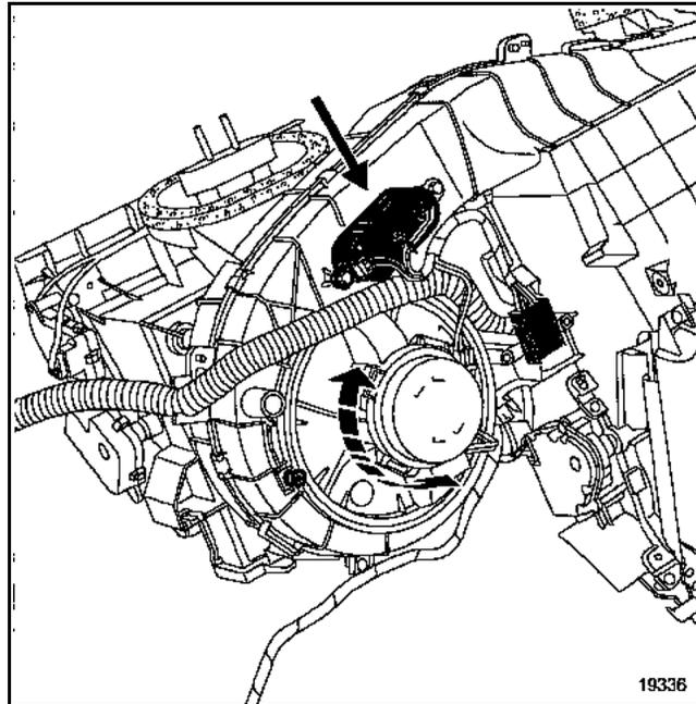
Le module de puissance pilote la vitesse du motoventilateur selon les besoins déterminés par la régulation.
