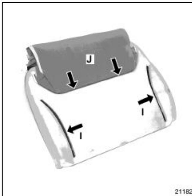
Rabattre simultanément l'avant et l'arrière de la coiffe vers la partie supérieure du dossier.
