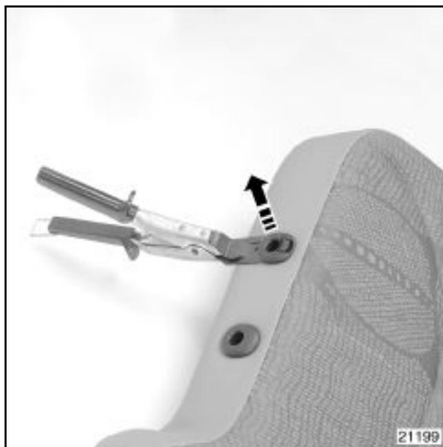
Déclipper les quatre caches guides d'appui-tête.
