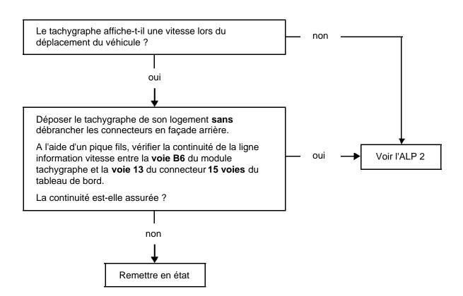
APRES REPARATION Procéder à un essai routier avec le véhicule pour valider la réparation.
