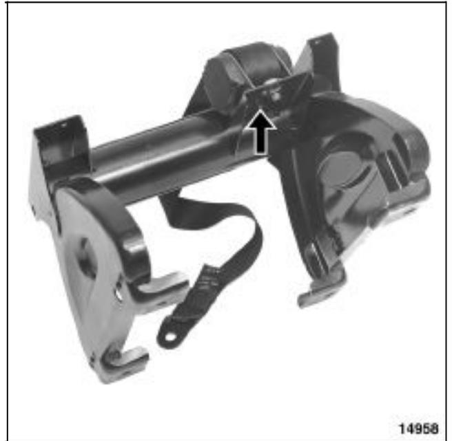
Lors du remontage de l'enrouleur, veiller à ce que le pion d'indexage se trouve dans son logement sur la réhausse avant de serrer la vis de fixation de l'enrouleur (voir ci-avant).
