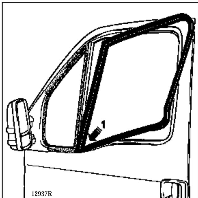
Mettre en place le coin moulé (1) sans forcer en se référant au joint d'encadrement de vitre fixe afin d'assurer une continuité entre les deux joints chaussés sur le montant fixe.
