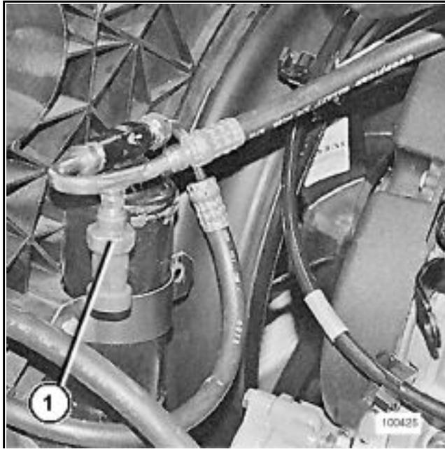
**NOTA** : toute intervention sur le pressostat peut se faire sans vidanger le circuit réfrigérant ; le pressostat est fixé sur une valve "**SKRADER**".
