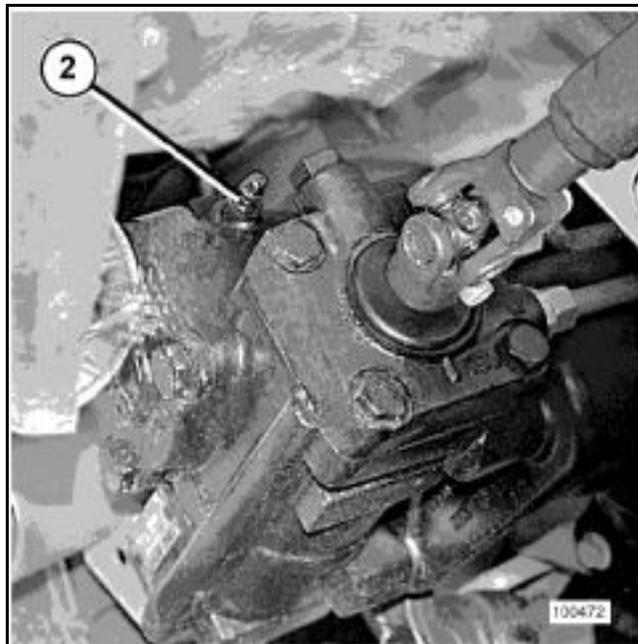
Ouvrir la vis de purge (2) (sans tourner le volant) jusqu'à ce l'huile s'écoule sans air.
