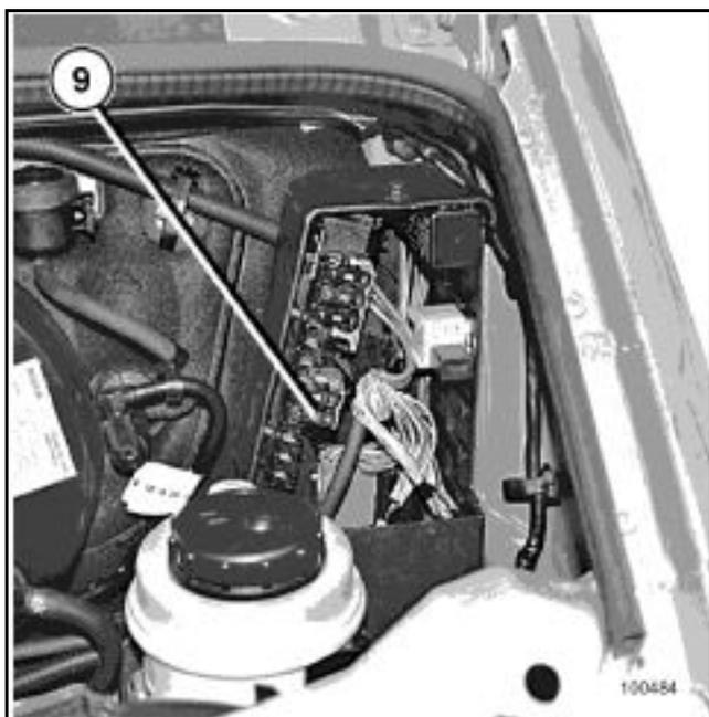
Débrancher les connecteurs du boîtier interconnexion moteur.
