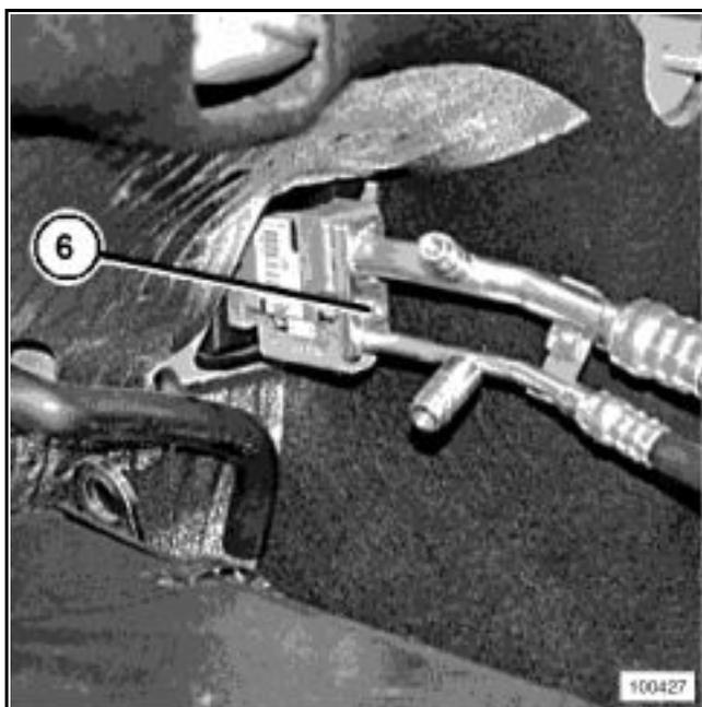
Déposer la fixation (6) des tuyaux de liaison sur le détendeur.
