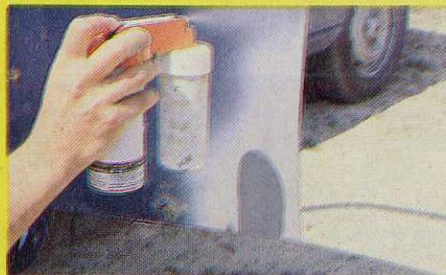
7. Pulvériser une couche d'apprêt cellulosique garnissant suffisamment mouillée pour faire disparaître les dernières imperfections. Laisser sécher 5 minutes avant d'appliquer la deuxième couche (séchage : 1 heure).
