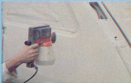
15. Passer un tampon d'essuyage sur la surface à peindre pour retirer les dernières poussières. Appliquer d'abord un voile de laque, puis une couche simple. Laisser sécher 5 minutes et terminer par une couche croisée.
