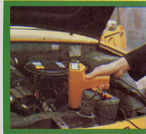
CONTROLE DU POINT D'ALLUMAGE A LA LAMPE STROBOSCOPIQUE (DOC. BOSCH)
