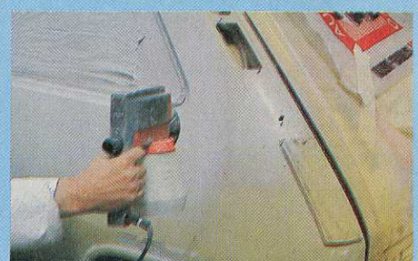
13. Pulvériser une couche d'apprêt cellulosique mouillée pour éliminer les dernières imperfections. Attendre 5 minutes avant d'appliquer la deuxième couche d'apprêt (séchage : 1 heure).
