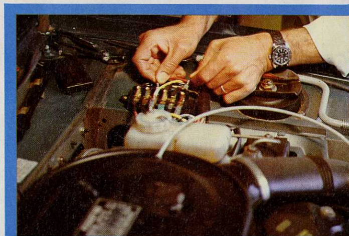
BRANCHEMENT SUR LE CIRCUIT ELECTRIQUE DU VEHICULE (DOC. SEV./VALEO)
