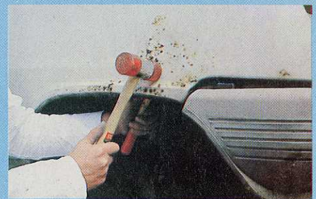
1. Redresser la tôle à l'aide d'un maillet.
