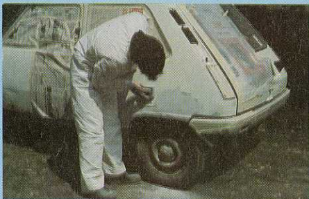
8. Poncer finement les bords de la zone masticquée au papier n° P 220 et le reste de l'élément au papier n° P 320/P 360.
