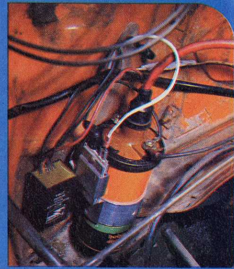
MONTAGE DEFINITIF DE LA NOUVELLE BOBINE (CLICHE E.A.)
