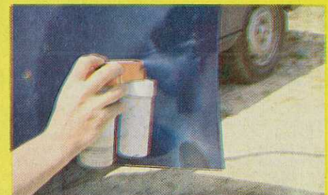
9. Passer un tampon d'essuyage sur la surface à peindre pour enlever les dernières poussières. Appliquer d'abord un voile de laque, puis une couche simple. Laisser sécher 5 minutes et terminer par une couche croisée.
