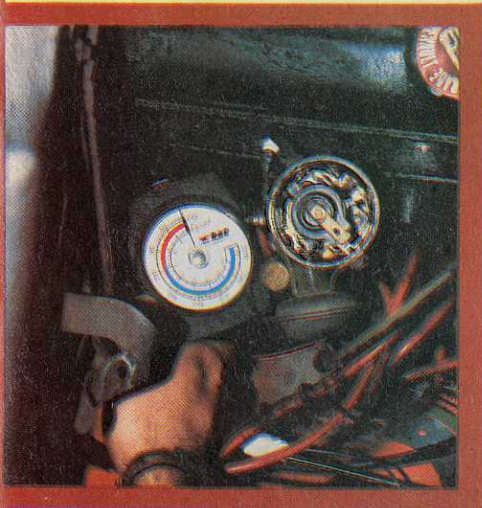
CONTROLE DES COMPRESSIONS DU MOTEUR (CLICHE E.A.).
