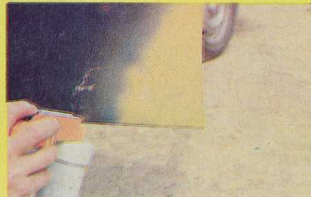
5. Protéger les surfaces voisines. Pulvériser un voile de primaire garnissant, puis deux couches en ménageant un temps d'évaporation entre chaque couche (séchage : 1 heure).
