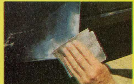
3. Dégrossir le ponçage au papier n° P 60.
