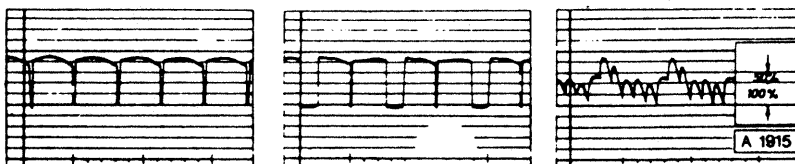
Défaut de phase (bobinage de stator en court-circuit ou interrompu).
