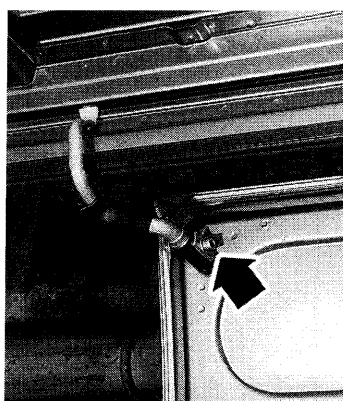
Vis de fixation du chariot de coulissement supérieur pour le réglage des jeux d'affleurement de la porte latérale coulissante.
