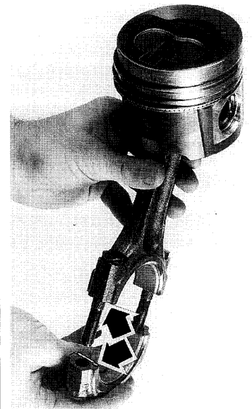
Assemblage bielle-piston. La chambre de turbulence sur la tête de piston doit se trouver du côté des ergots de coussinets de bielles (flèches).
