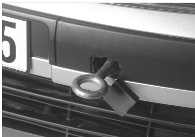
Implantation de l'anneau de remorquage à l'avant
