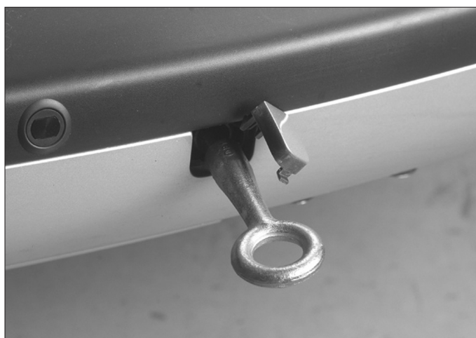
Implantation de l'anneau de remorquage à l'arrière
