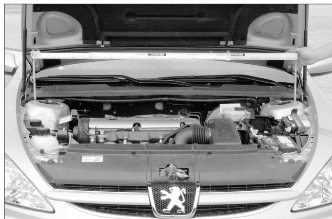
Contrôle N°3 : 1 265 mm, mesuré entre les deux vis extérieures d'amortisseurs.
