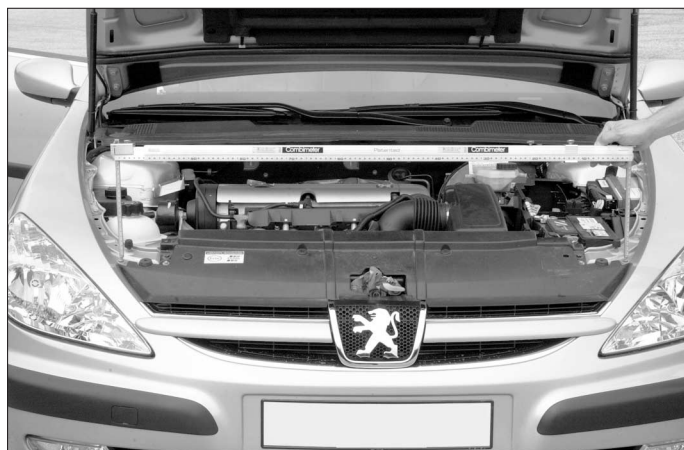
Contrôle N°1 : 1 058 mm, mesuré entre les deux vis avant d'aile.
