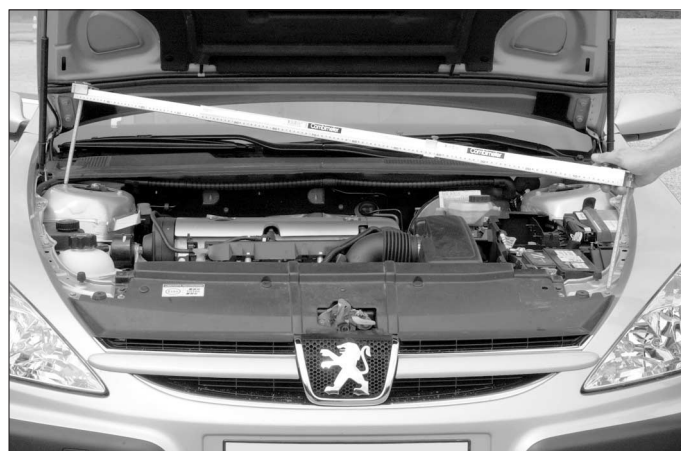
Contrôle N°4 : 1 356 mm, mesuré entre la vis extérieure d'amortisseur droit et la vis avant d'aile gauche (contrôle symétrique).
