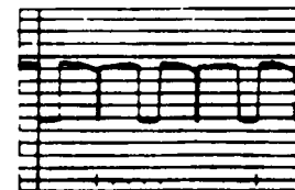
Défaut de phase et diode négative en court-circuit
