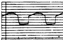
Court-circuit d'une diode excitatrice
