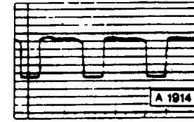
Court-circuit d'une diode négative
