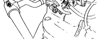
— Fermer la vis de purge (4) et (5) dès que le liquide s'écoule (filet continu).
