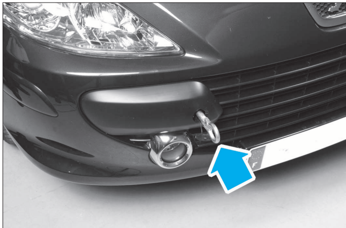
Position du point d'attache avant.
