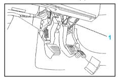
Déposer le contacteur (1) en faisant levier avec un tournevis plat.
