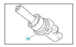
Nota: contrôler le retrait de la tige de poussée de l'amplificateur de freinage X = 19,85 ± 1,3 mm (cette cote est prise entre la face d'appui du maître-cylindre et la tête de la tige de poussée).
