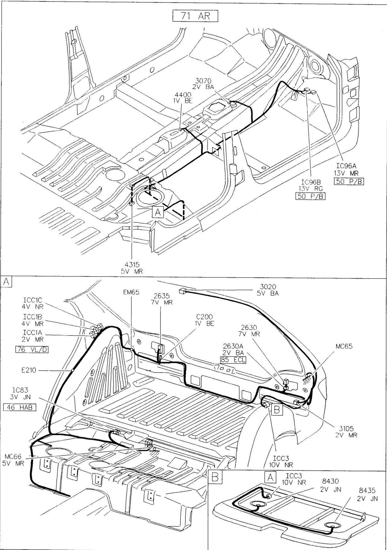
FAISCEAUX 71 AR (FAISCEAU ARRIÈRE) (4 PORTES)
