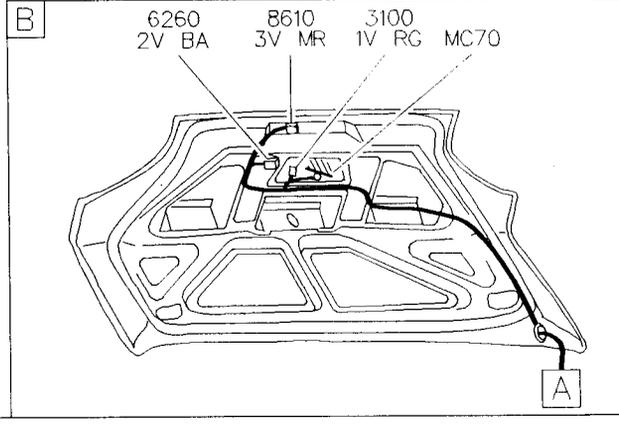
FAISCEAUX 71 AR (FAISCEAU ARRIÈRE) (BREAK)
