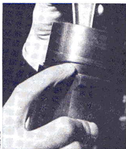
Au montage, s'assurer que les joints toriques des chemises ne sont pas vrillées
