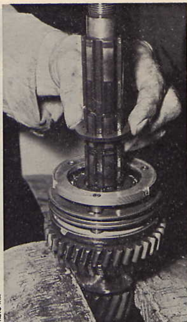
Mise en place de la rondelle entretoise sur le synchro de 1 re -2 e
