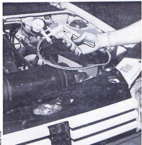
Pour contrôler l'avance à dépression sur véhicule, brancher une pompe à dépression sur la capsule
