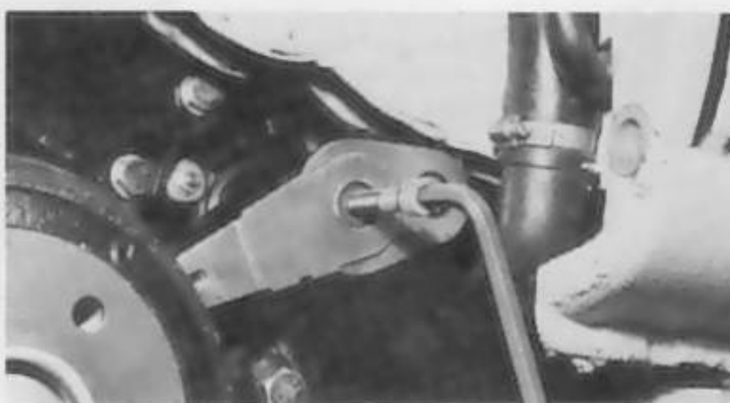
Extraction du levier de barre stabilisatrice (vis 7.0908 A)
