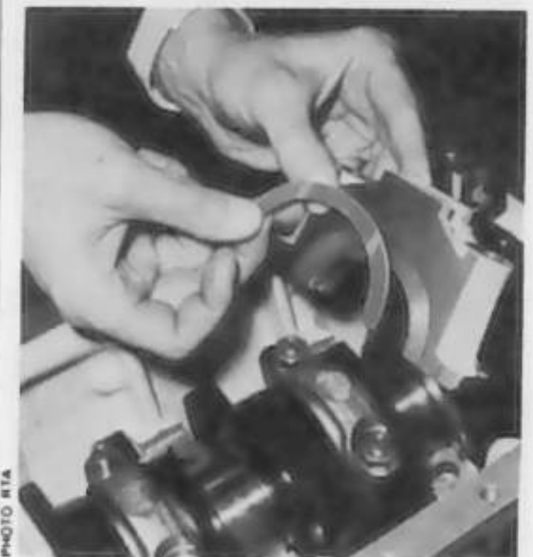
Dépose des cales de latéral
