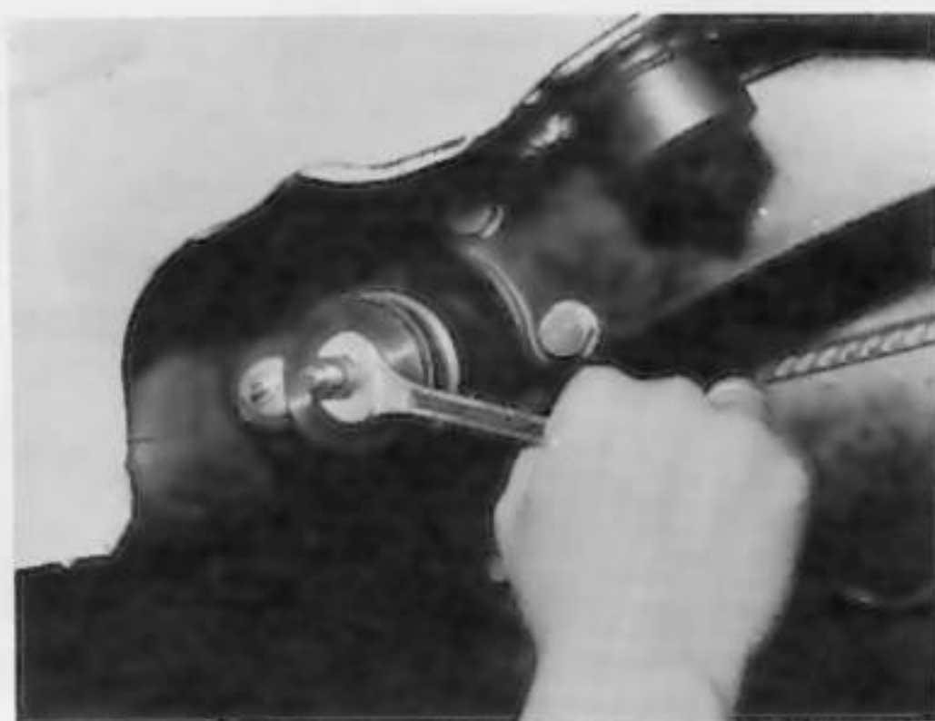
Mise en place de la cage à aiguilles intérieure dans l'alésage du bras de suspension
