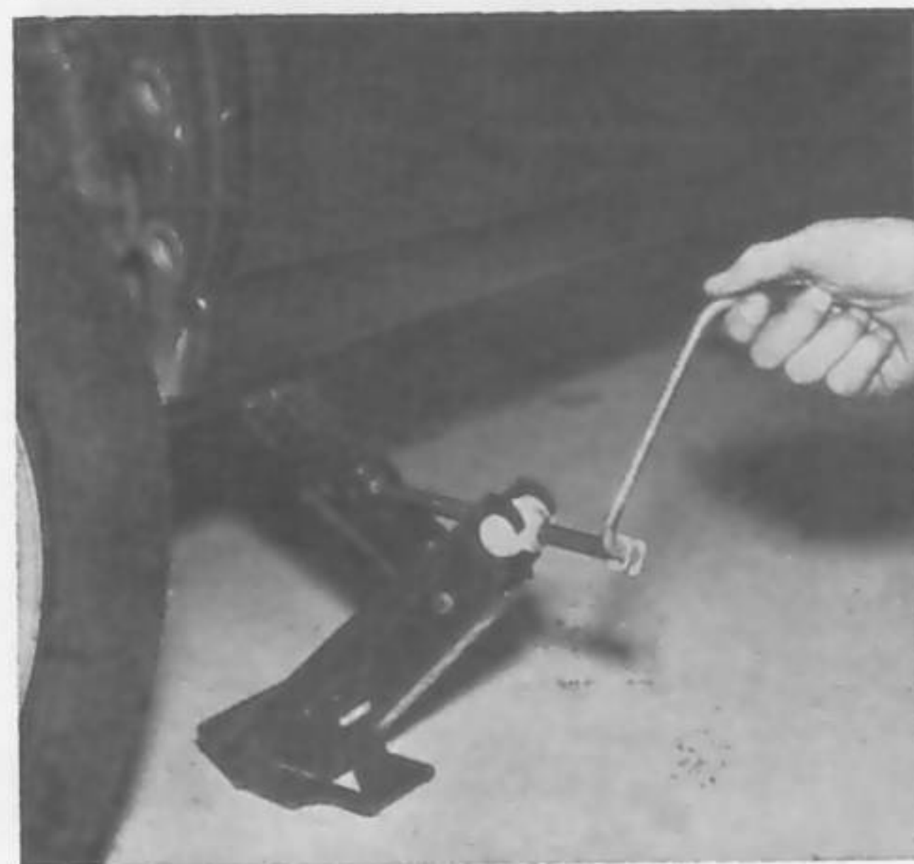
Mise en place du cric.
