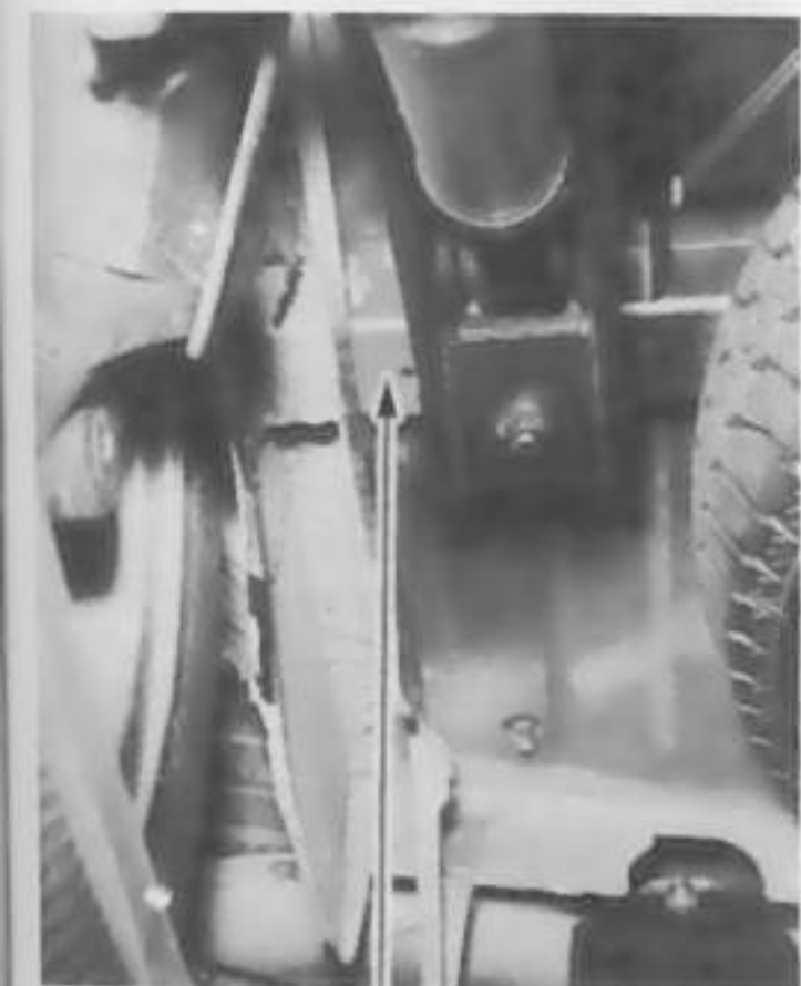
Point de mesure de la hauteur d'assiette H = 430 \pm 7 mm
