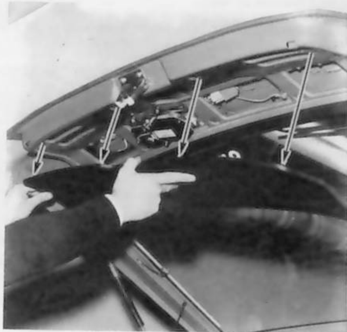
Dégager la garniture de hayon pour accéder au moteur d'essuie-glace arrière
