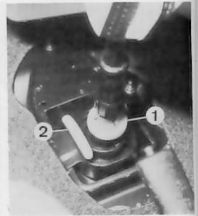
1. Excentrique - 2. Butée de sûreté de marche arrière
