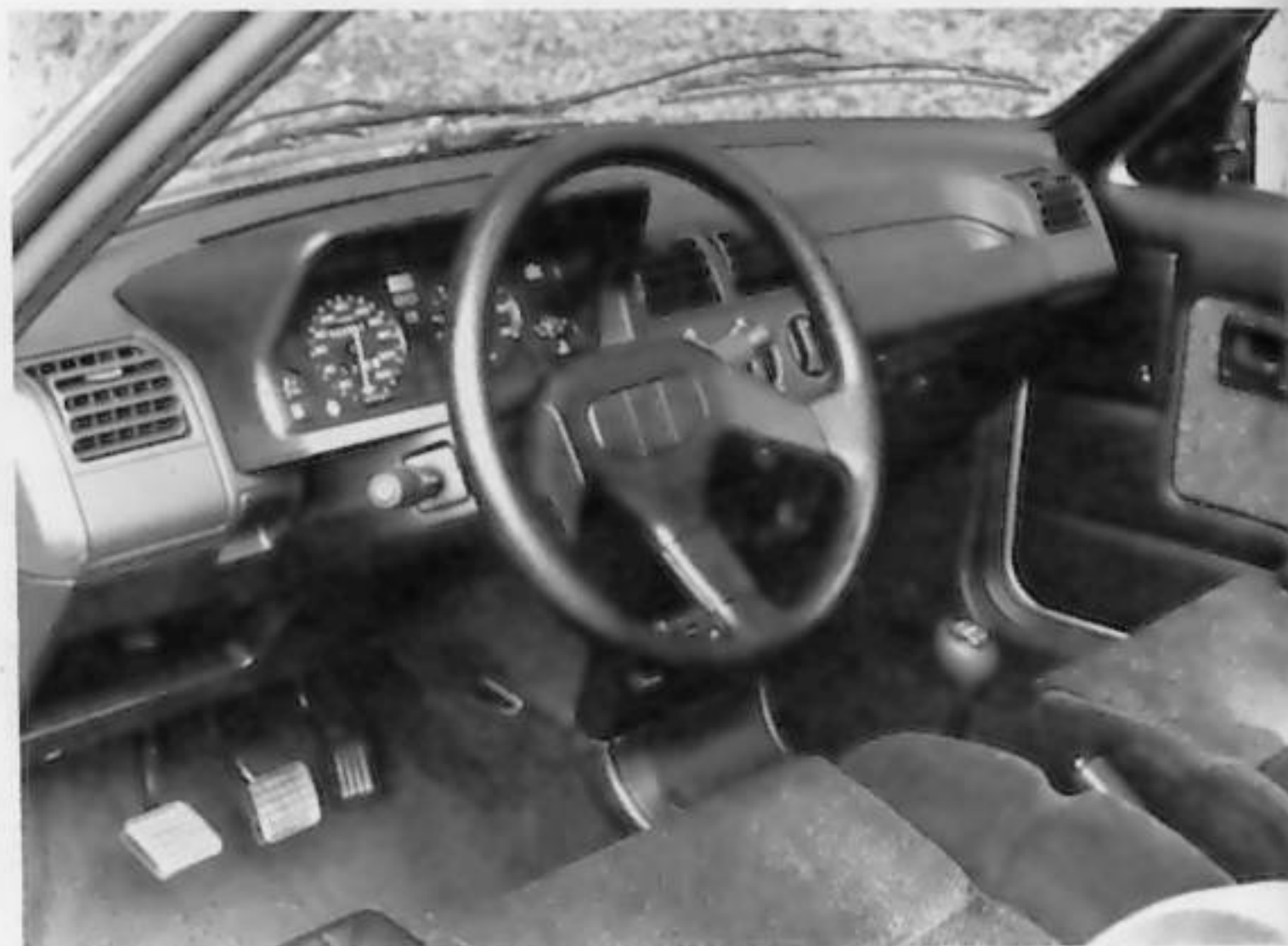
Planche de bord des modèles 1988, hormis les commodos au volant, les commandes sont identiques aux modèles précédents. La XTD bénéficie d'un combiné d'instrument sous visière comme les 205 XT essence.
