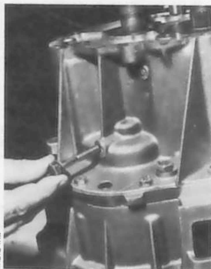
Montage de la vis d'arrêt d'axe de la marche arrière
