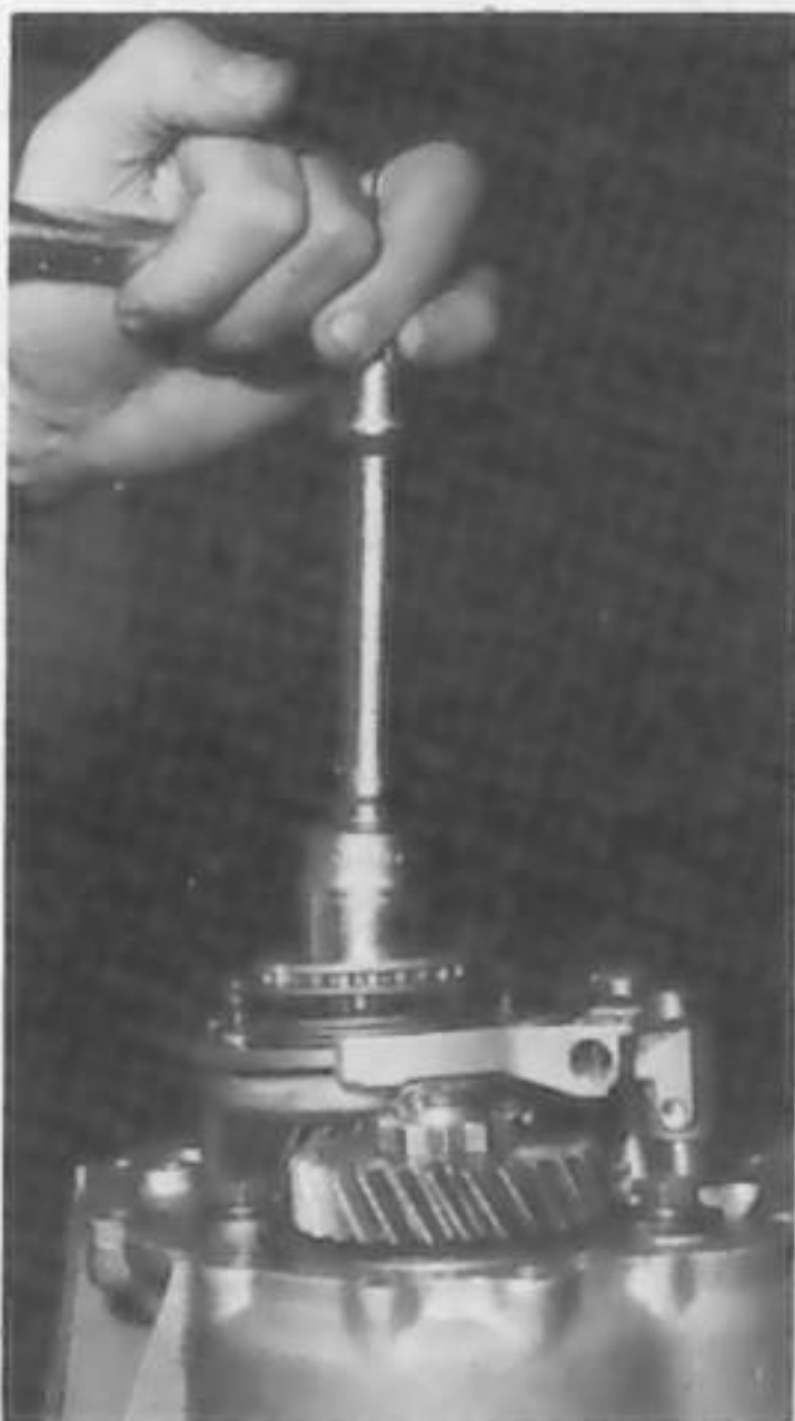
Dépose de l'écrou d'arbre secondaire (douille de 28 douze pans)
