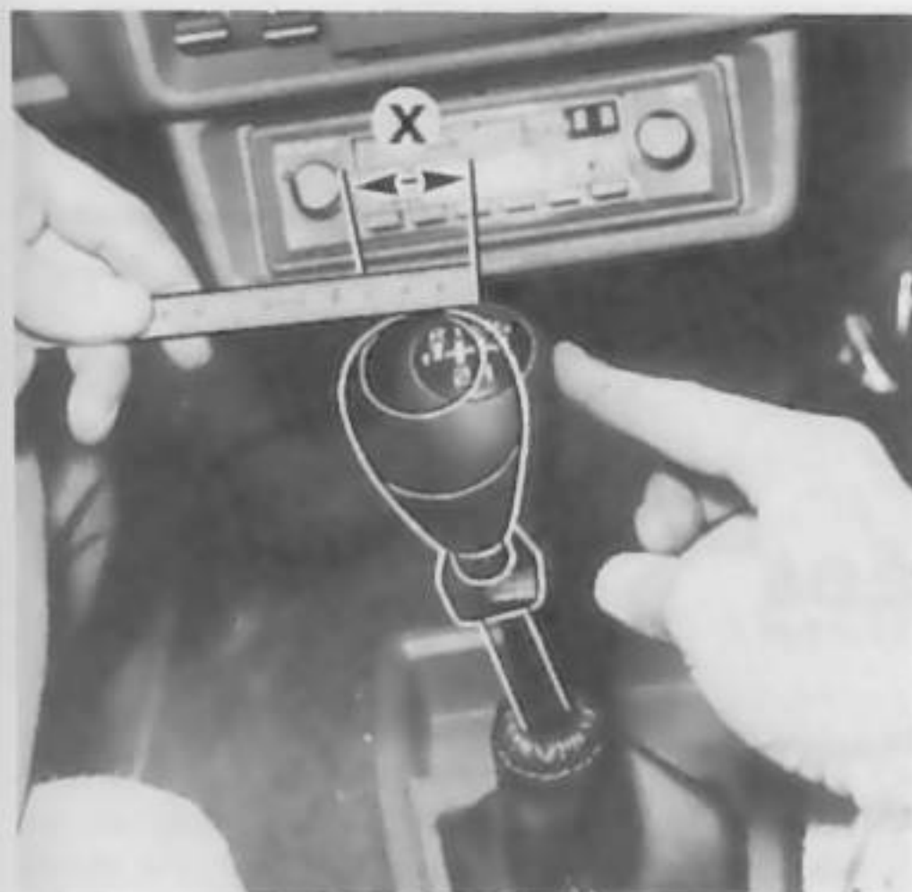
Réglage de la commande de boîte de vitesses. X = 38 \pm 2 mm
