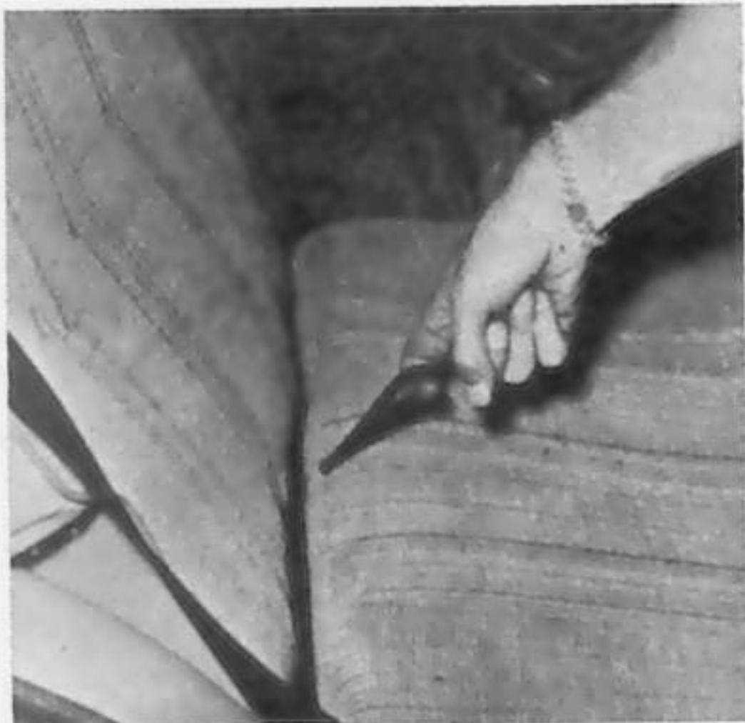
Assise rabattable sur versions à siège unique. Sangle de levage du coussin. (Photo RTA).
