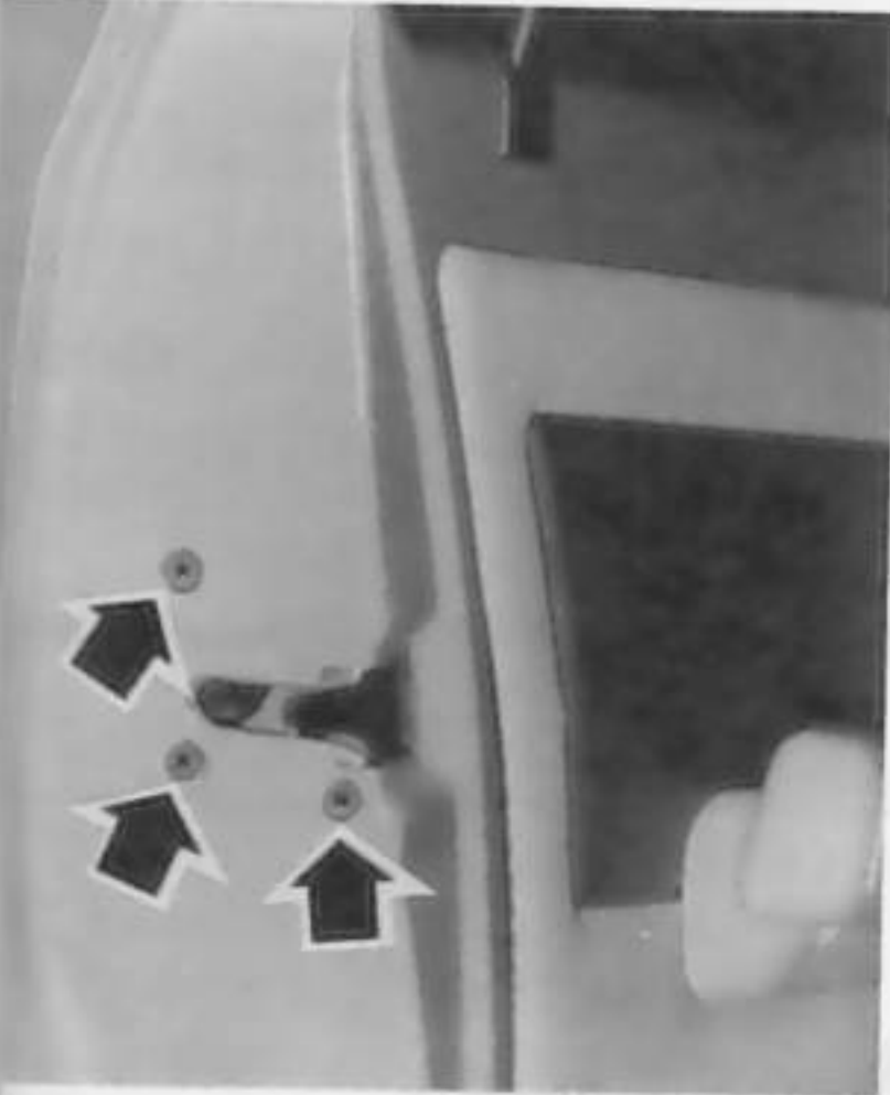
Les serrures de porte sont fixées sur l'extérieur du caisson avec des vis « Torx »
