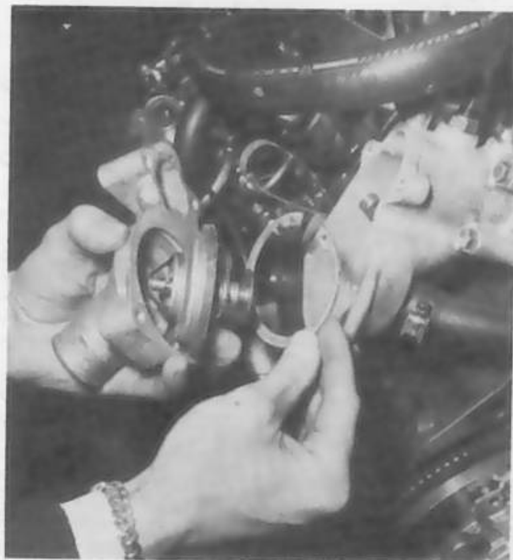
Sens de montage du thermostat dans le couvercle
