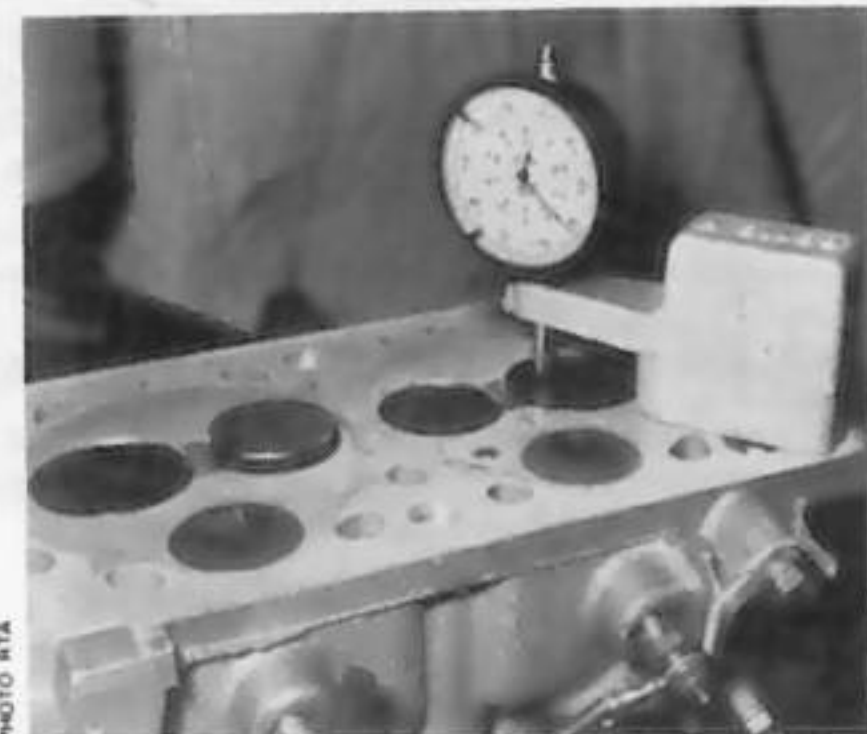
Contrôle du retrait des soupapes
