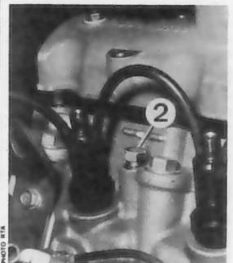
2. Bouchon de visite du 4° cylindre dans la culasse
