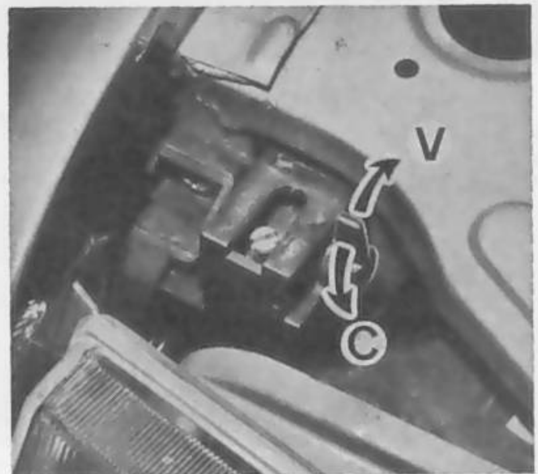
Levier correcteur de charge. V. : vide - C. : chargé. (Photo RTA).
