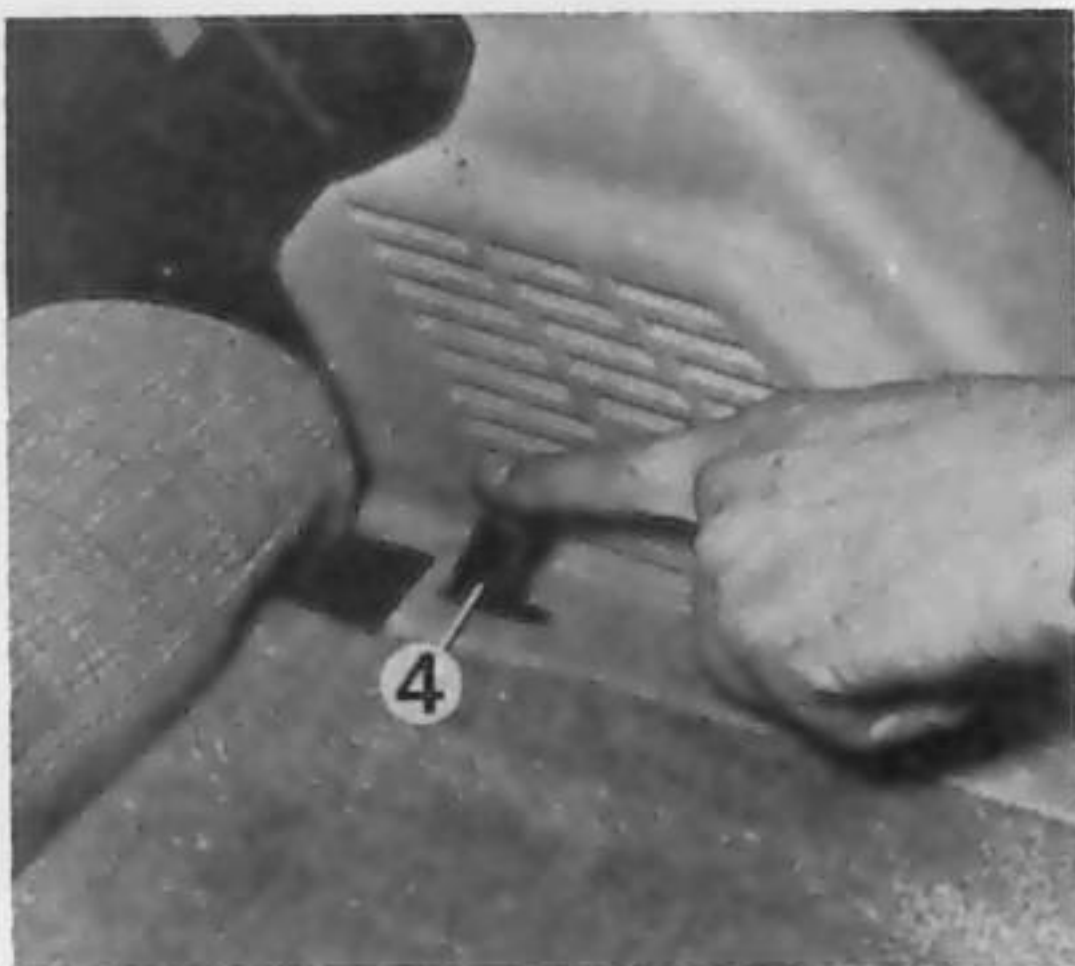
Dossier arrière rabattable. Emplacement du levier de déverrouillage (4). Levier identique côté opposé. (Photo RTA).
