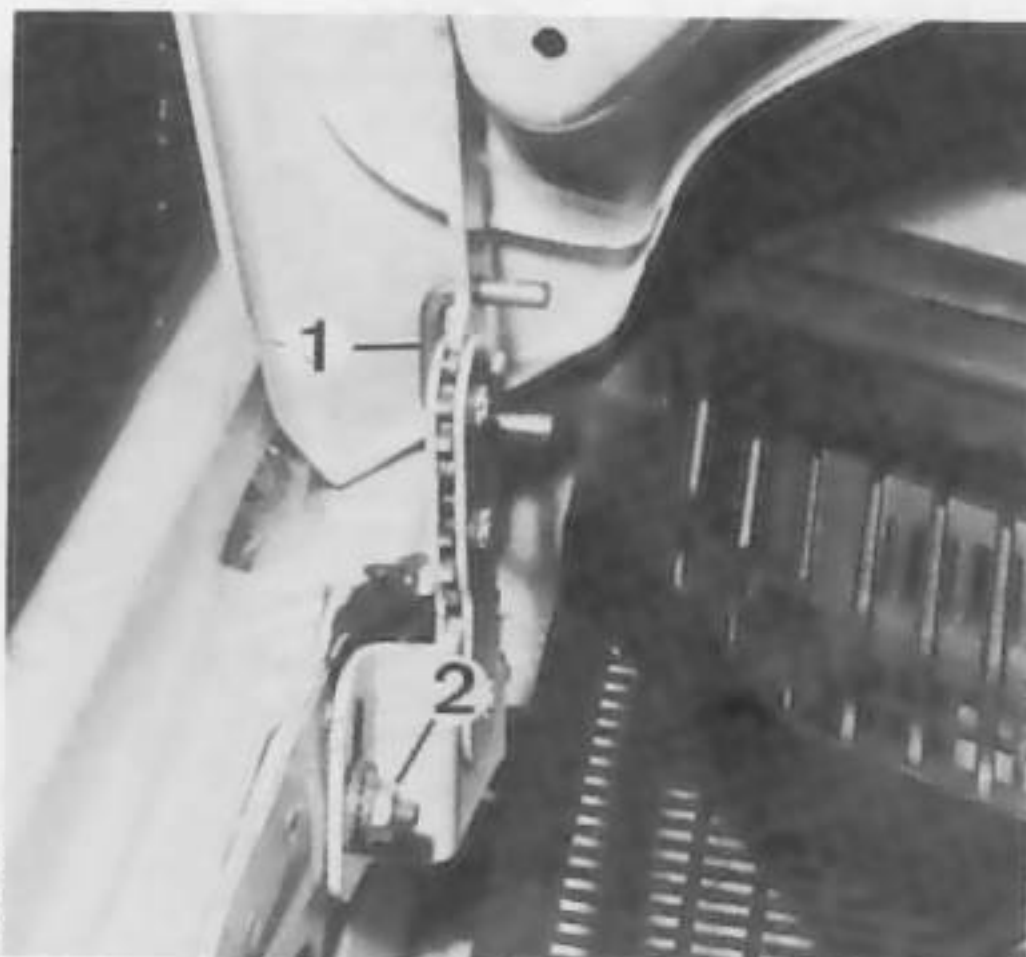
Ci-contre : 1. Cavalier de verrouillage des charnières de capot - 2. Ecrou de charnière
