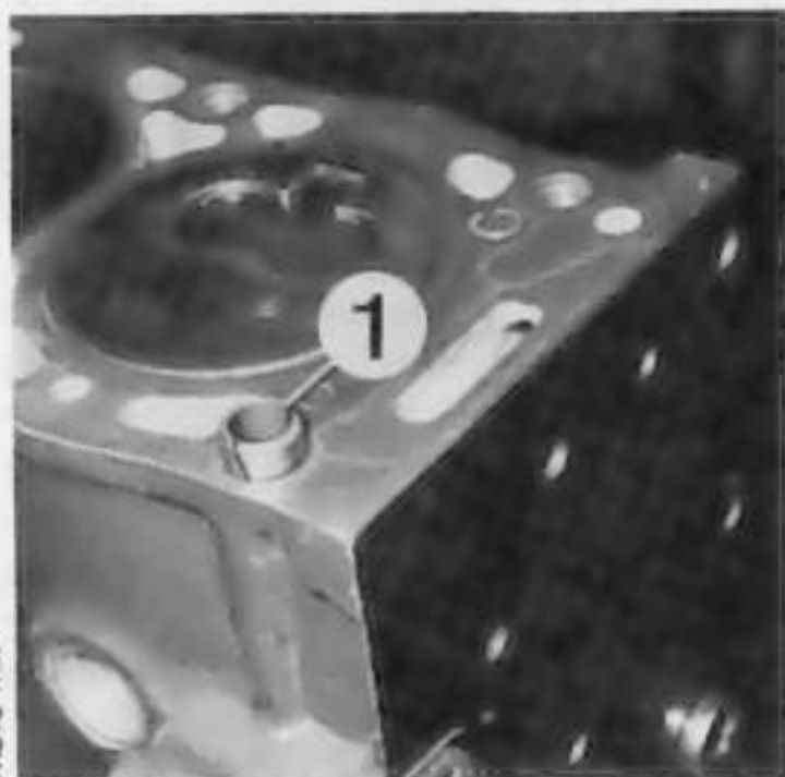
1. Goupille de centrage dans la culasse
