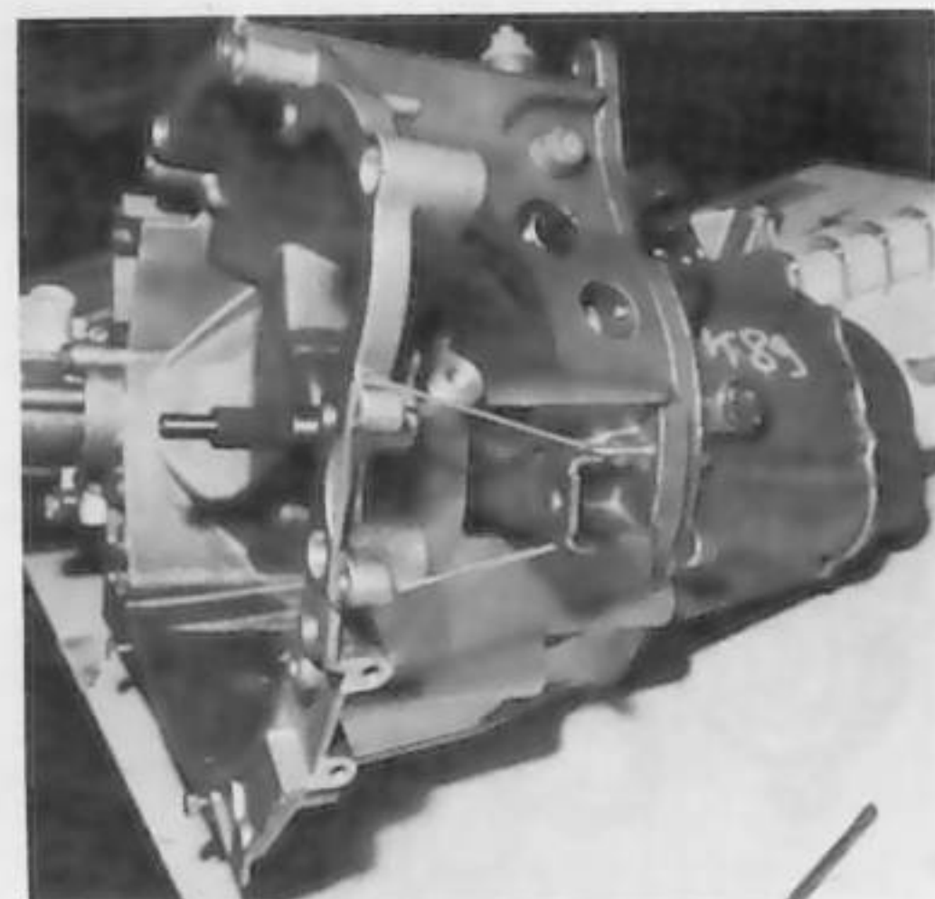
Bridage de la fourchette sur le carter à l'aide d'un élastique pour la repose de la boîte
