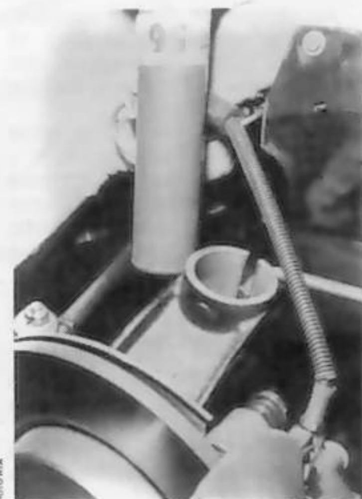
Dégagement de la jambe de suspension, clé (8.0903 AE) en place.
