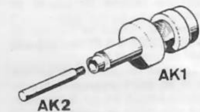
Outils spécifiques au calage de la pompe d'injection Bosch
