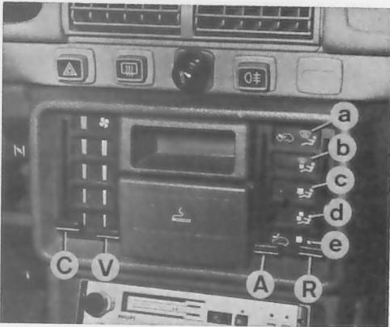
Commandes de chauffage-ventilation. (Photo RTA).
