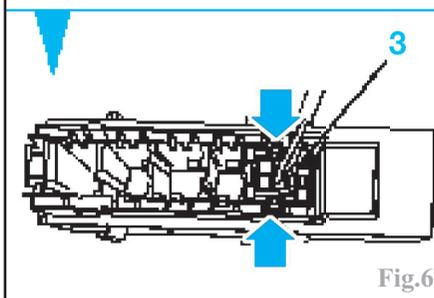
Déposer le collier du faisceau électrique. Déposer la vis de fixation et retirer le prétensionneur de ceinture.
