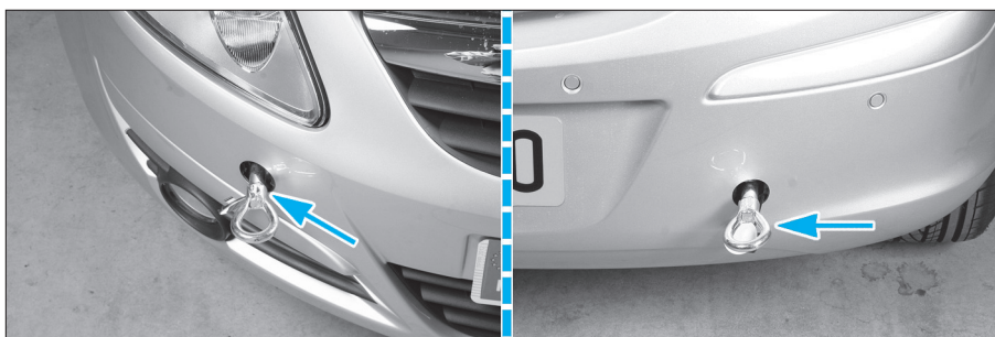
Implantation des crochets de remorquage
