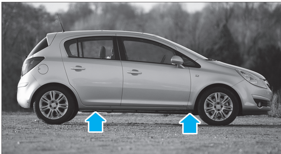
Implantation des points de levage
