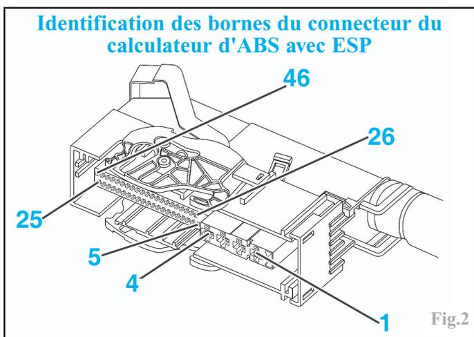
**Affectations des bornes du calculateur d'ABS avec ESP (Fig.2)**
