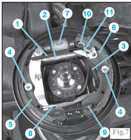
Déposer le dispositif de rattrapage de jeu automatique comprenant le levier de rattrapage (2), l'agrafe de retenue (10), le levier de réglage (11) et le ressort (3).
