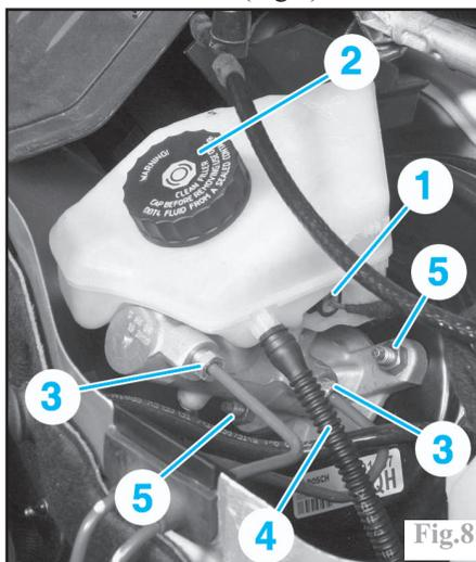
Déposer le bouchon (2) du réservoir de compensation.
