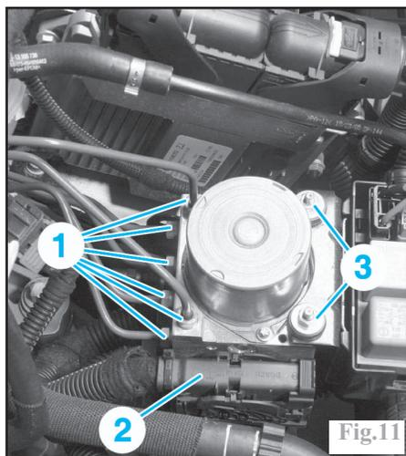
Débrancher les six canalisations de frein (1) sur le groupe hydraulique (Fig.11) après avoir repéré leur position.
