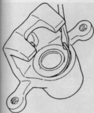
Dépose du jonc d'arrêt du cache-poussières d'un étrier arrière.
