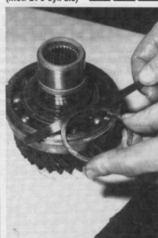
Choix d'un segment d'arrêt d'arbre primaire.
