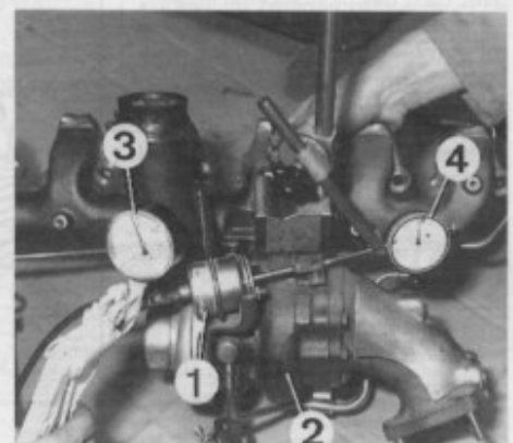
Contrôle de la soupape de régulation 1. Soupape - 2. Turbocompresseur - 3. Pompe à dépression - 4. Comparateur.
