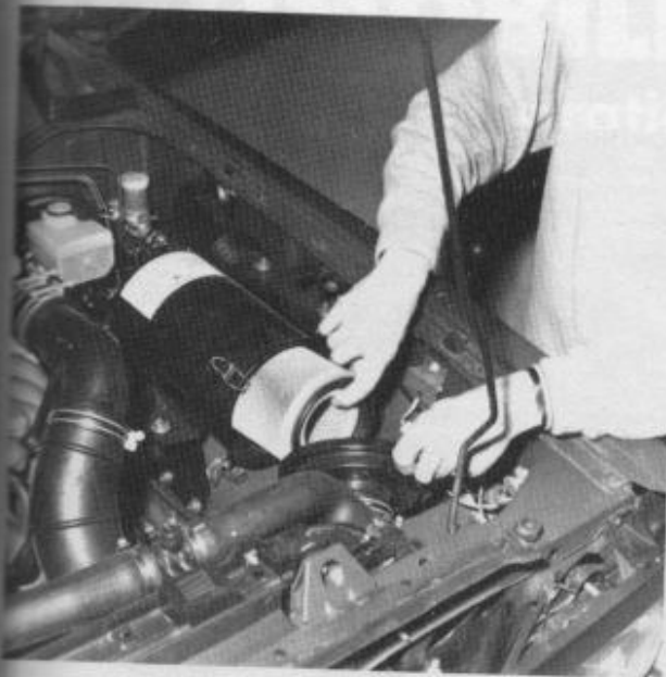
Remplacement de la cartouche filtrante du filtre à air (Photo RTA) Ci-dessus : sur 260 - Ci-dessous : sur GR.
