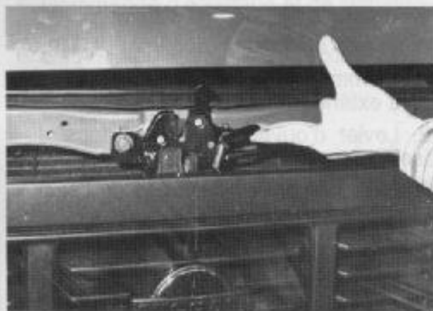
Déverrouillage du crochet de sécurité (Photo RTA)
