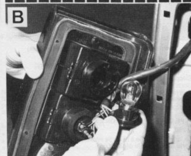
Remplacement des lampes de feux arrière sur 260 (Photos RTA) A. V : Emplacement de la vis de maintien du boîtier - B. Dépose d'une lampe.
