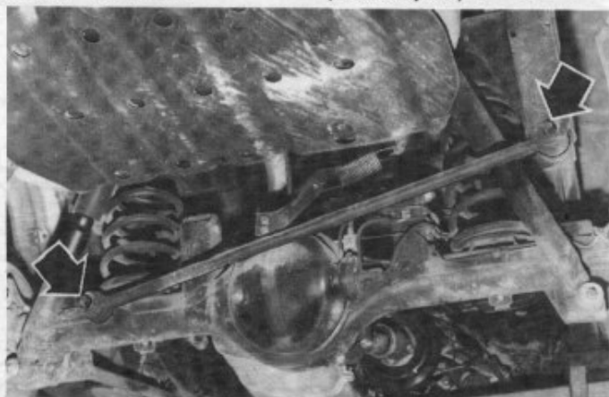
Train arrière (Patrol GR) Flèches : Fixation de la barre transversale Panhard.
