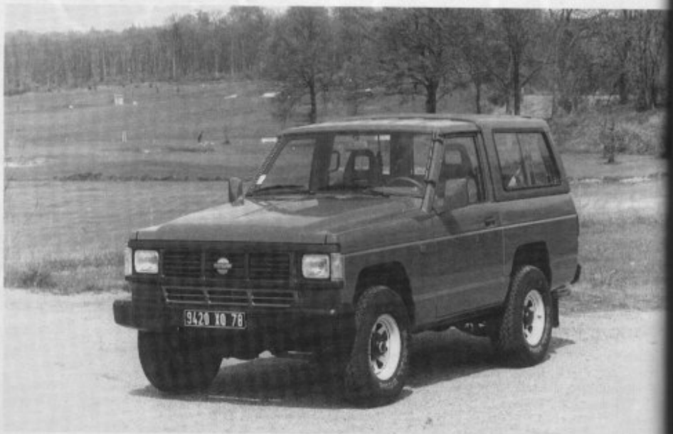
Le Patrol traditionnel conserve la même silhouette depuis une douzaine d'années mais il a reçu différents moteurs pour arriver au 6 cylindres 2,8 litres actuel. (Photo RTA).
