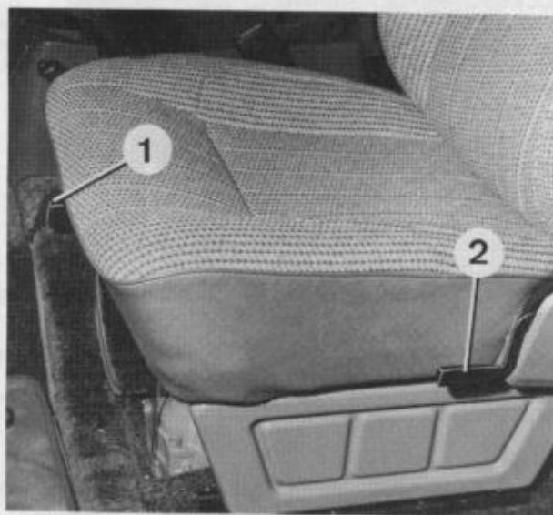
Réglage siège avant (Photo RTA) 1. Réglage longitudinal - 2. Réglage de l'inclinaison du dossier.
