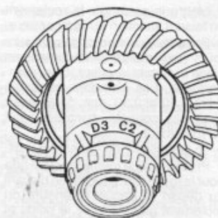
Repères C et D du porte-satellite (pont C 200).
