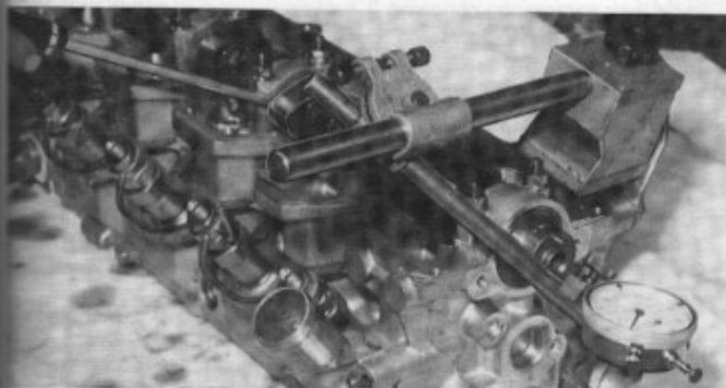
Contrôle du jeu axial de l'arbre à cames.
