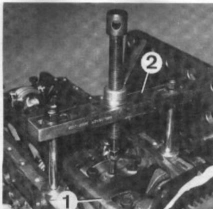
Dépose de la rampe de chapeaux de paliers 1. Rampe - 2. Extracteur.
