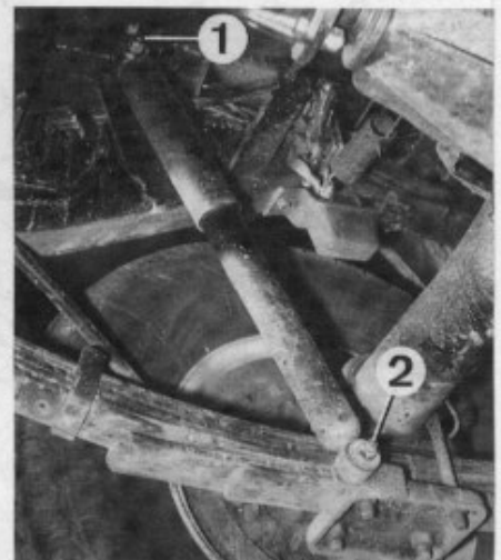
Fixations d'un amortisseur (Patrol 260) 1. Supérieure - 2. Inférieure.
