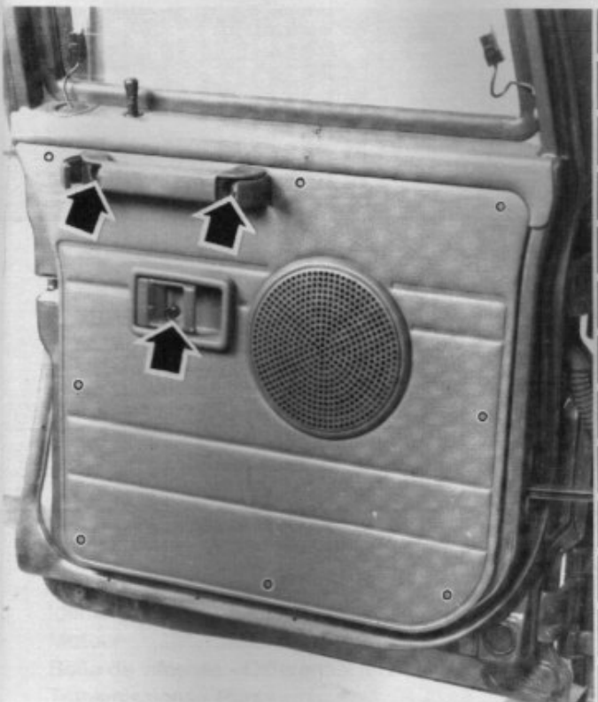
Points de fixation des garnitures de portes arrière
