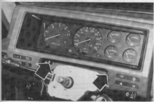
Vis de fixation de la casquette du combiné d'instruments (Patrol 260).
