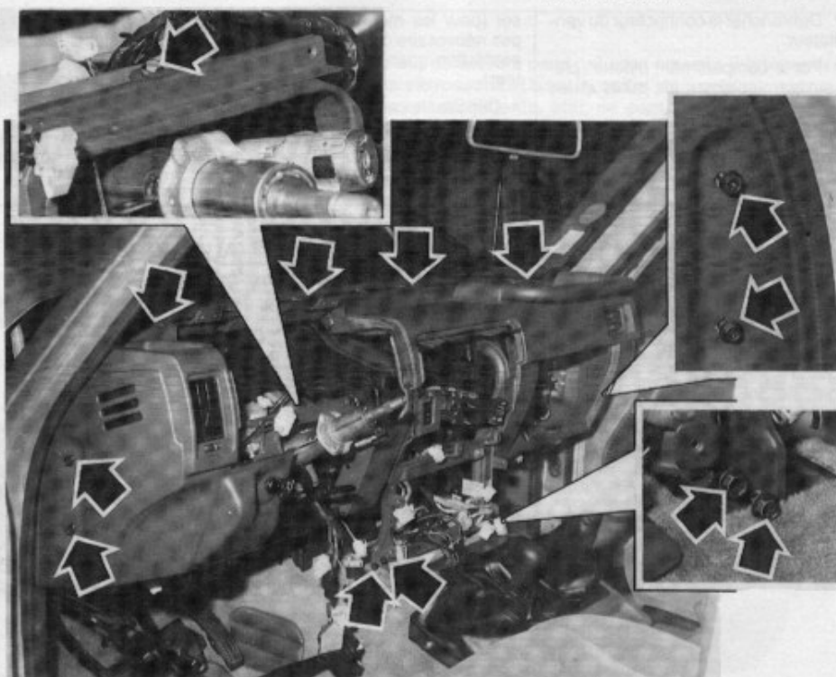
Vis de fixation de la planche de bord (Patrol GR).
