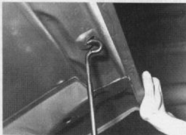
Mise en place la béquille de maintien (Photo RTA)
