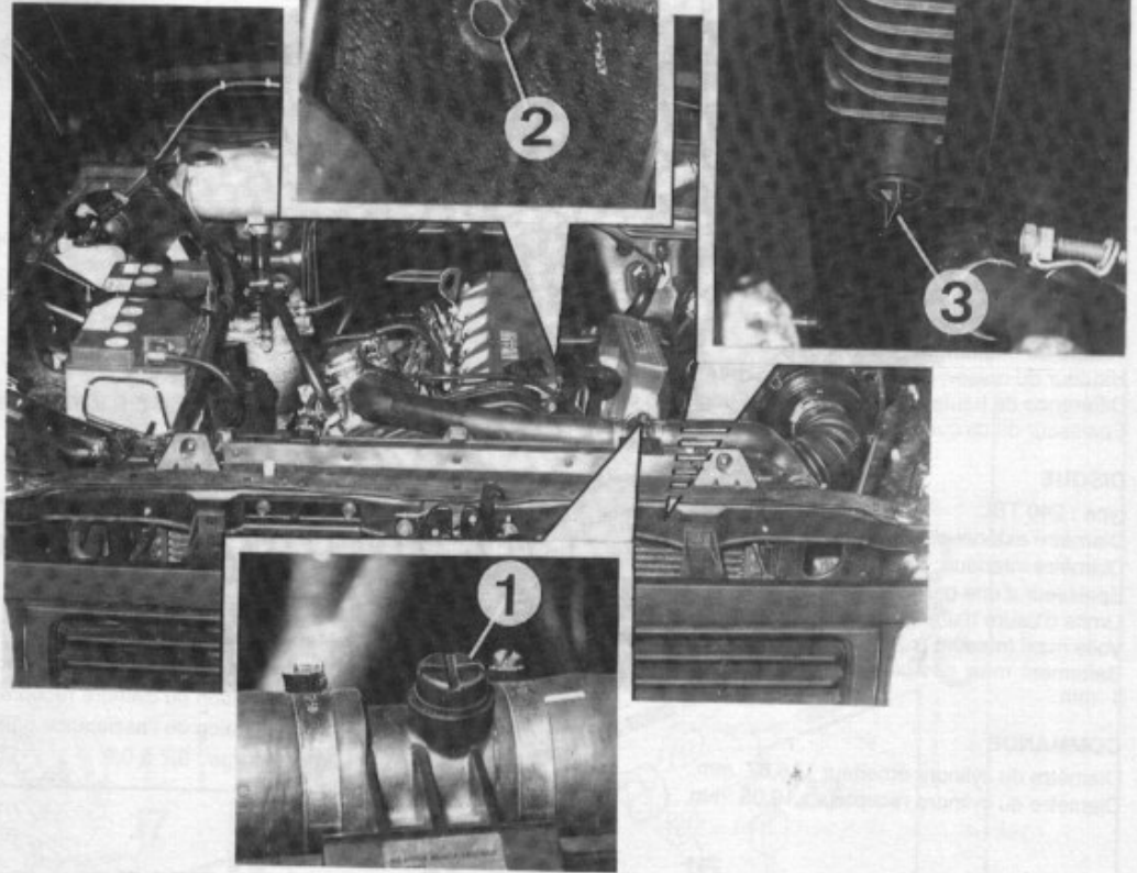
Circuit de refroidissement 1. Bouchon de purge - 2. Bouchon de vidange du bloc - 3. Bouchon de vidange du radiateur.
