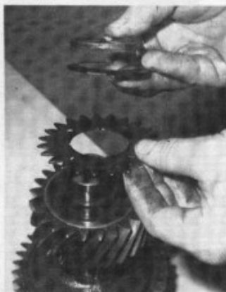
Montage des composants de l'arbre intermédiaire, respecter l'orientation de la rondelle élastique.
