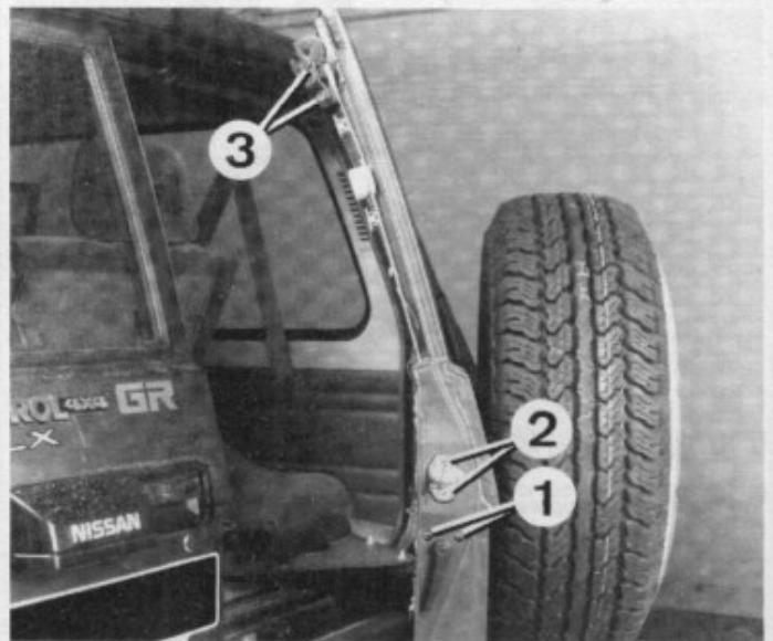
Dépose du système d'ouverture de porte arrière droite de Patrol GR 1. Vis de fixation de la serrure - 2. Vis de fixation de la gâche - 3. Vis de fixation de la serrure.
