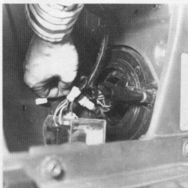
Remplacement d'une lampe de feu de position (Photo RTA)
