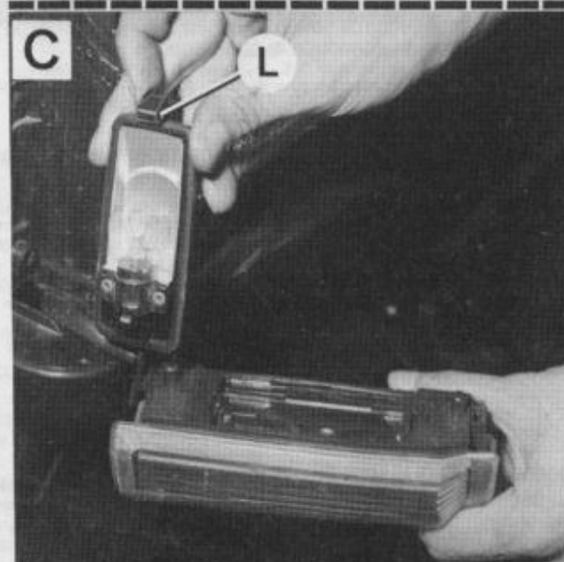
Remplacement d'une lampe de clignotant sur 260 (Photo RTA) A. Dépose du boîtier de clignotant - V. Vis de maintien - B. Dépose du porte-lampe - C. Porte-lampe déposé - L. Languette de maintien du porte-lampe dans le boîtier.
