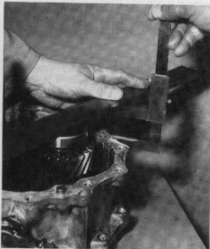
Mesure du dépassement de l'arbre intermédiaire pour déterminer la cote de réglage.
