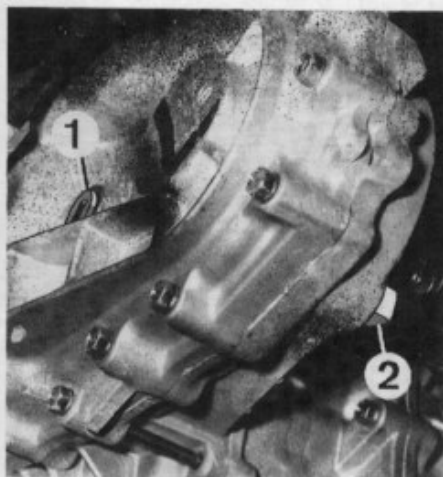
Implantation des bouchons sur le carter de boîte de transfert 1. Remplissage et niveau - 2. Vidange.
