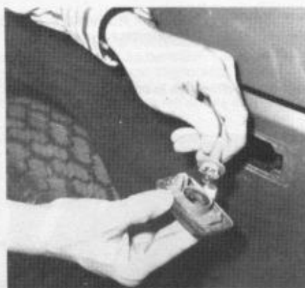
Remplacement de la lampe de clignotant latéral (Photo RTA)
