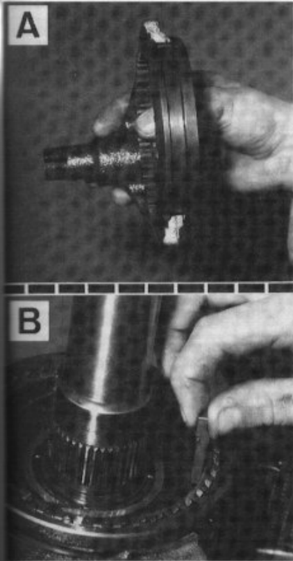
Montage de la commande de 4 roues motrices A. Orientation du manchon baladeur - B. Montage des lardons de verrouillage.
