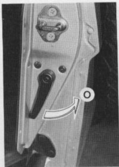
Ouverture porte droite du hayon sur GR (Photo RTA) O. Tirer sur la poignée pour ouvrir.
