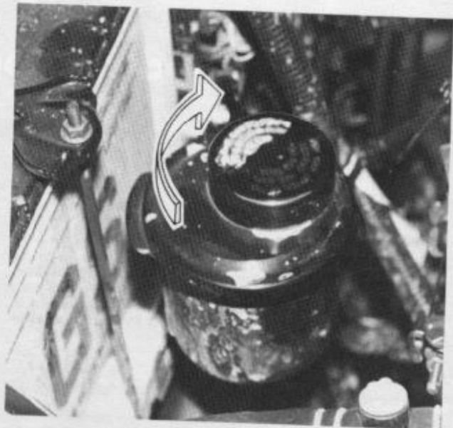
Réservoir d'huile de direction assistée sur GR (Photo RTA) Emplacement identique sur 260.
