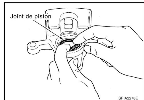
2. Appliquer du liquide de frein au piston puis appliquer de la graisse pour caoutchouc sur le soufflet de piston. Couvrir l'extrémité de piston avec le soufflet de piston puis reposer correctement la lèvre côté cylindre du soufflet de piston dans la rainure située sur le corps de cylindre.
