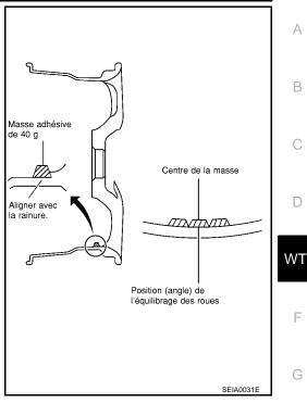
c. Si la valeur calculée de la masse d'équilibrage est supérieure à 50 g, reposer 2 bandes de masse d'équilibrage en les alignant l'une à l'autre (comme indiqué sur l'illustration).
